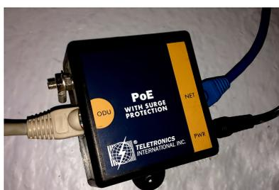
**Figura 165 Conexión del PoE (IDU) mediante Cable Ethernet Sucursal Tanda**
