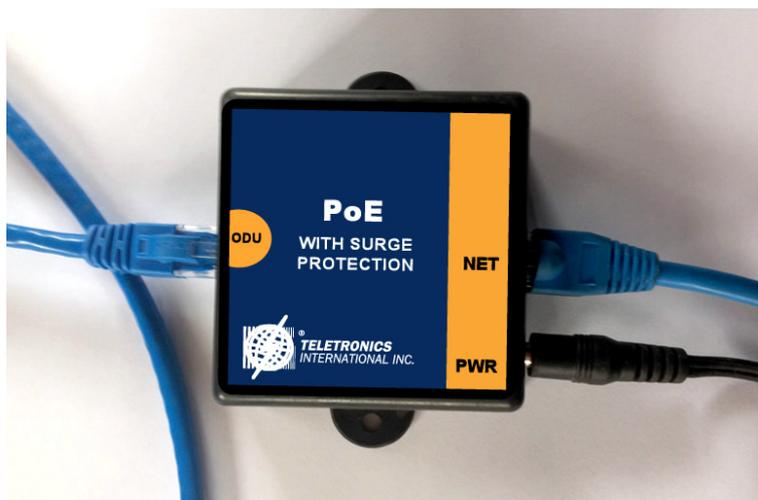
**Figura 153 Conexión del PoE (IDU) mediante Cable Ethernet Matriz
