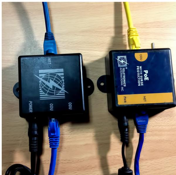
**Figura 169 Conexiones del PoE (IDU) mediante Cable Ethernet
