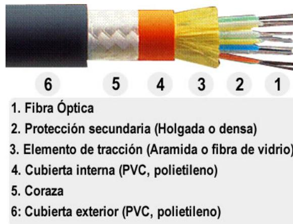
**Figura 5 Estructura del cable de fibra óptica**
