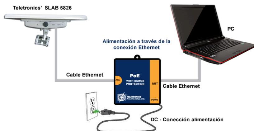
**Figura 106 Esquema de conexión de componentes para realizar la configuración**
