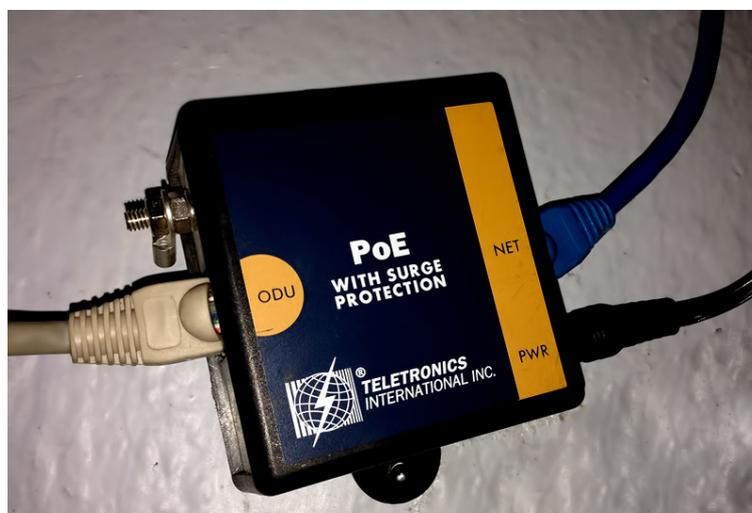
**Figura 161 Conexión del PoE (IDU) mediante Cable Ethernet Sucursal Cumbayá**
