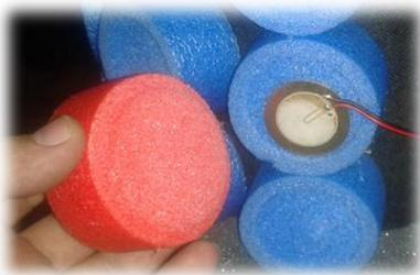
Figura3: Sensor Piezoeléctrico montado sobre capsula de polietileno reticulado.
