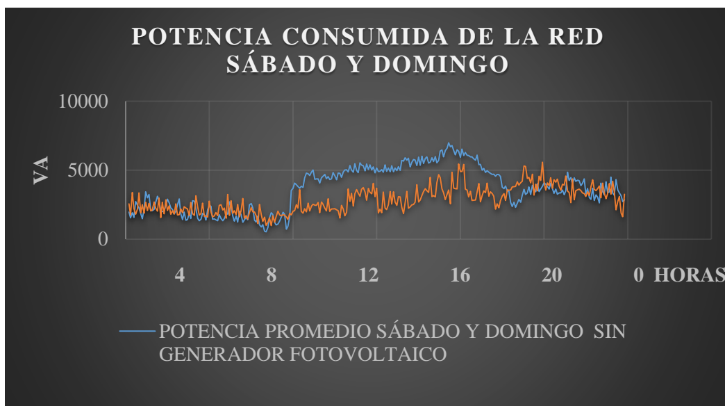
Figura 4. 17 Potencia consumida sin Generador Fotovoltaico vs Potencia consumida con Generador Fotovoltaico – Sábado y Domingo.
