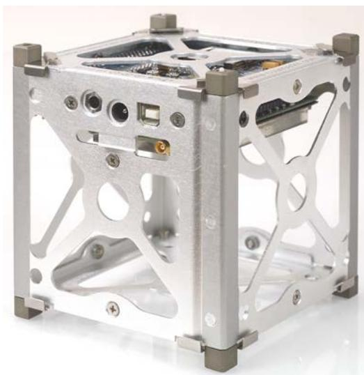
Figura 1. Chasis del nanosatélite CubeSat.
