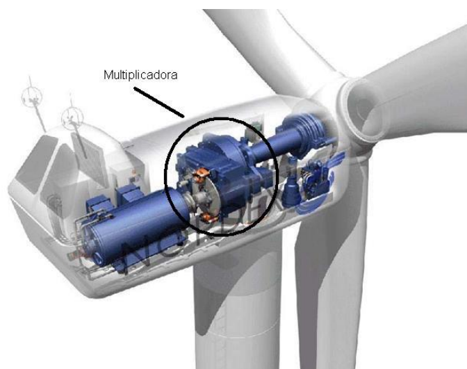
Figura 2.19 Caja de engranajes del aerogenerador
