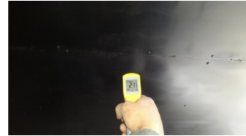
Figura 28. Temperatura en recubrimiento de pared frontal a los quemadores
