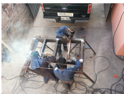
Figura 7. Estructura para la base del horno crematorio de mascotas
