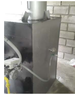
Figura 22. Terminado posterior y termocupla tipo K
