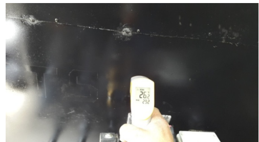
Figura 30. Temperatura en recubrimiento de pared de quemadores
