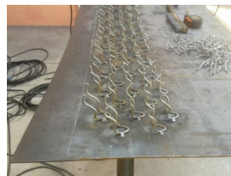
Figura 8. Anclajes para refractario de las paredes
