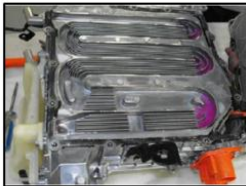
Figura 2.14. Conductos de refrigeración de un inversor
