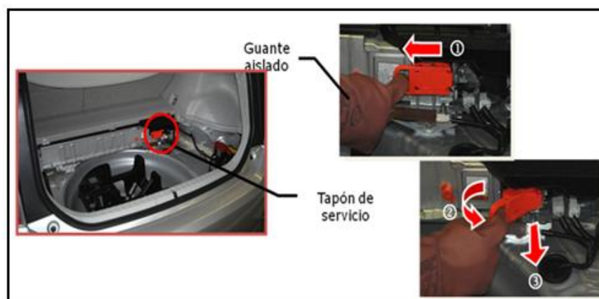
Figura 2.41. Jumper de seguridad
