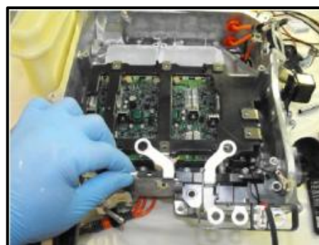
Figura 2.13. Interior del inversor del Toyota Prius
