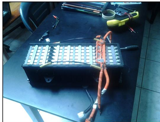
Figura 5.9. Bloque 3 baterías Highlander Realizado por: Ávila, Erazo, Quiroz
