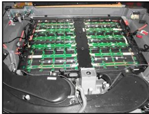
Figura 2.34. Disposición de celdas de la batería del Ford Escape
