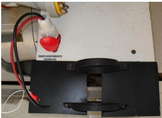
Figura 10. Módulo asentamiento escobillas.
