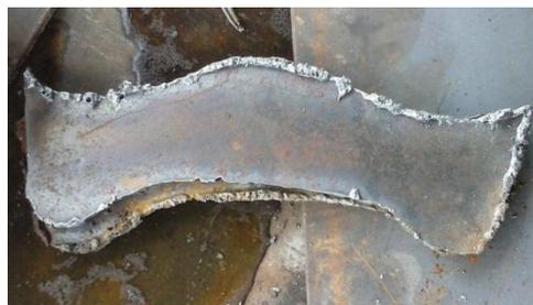
**Figura 4. 11 Piezas cortadas del balancín**
