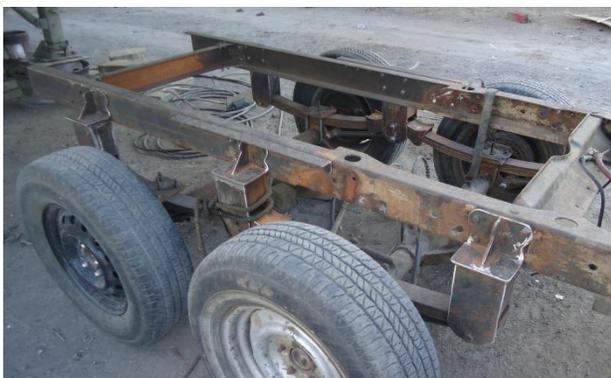
**Figura 4. 24 Chasis ensamblado**
