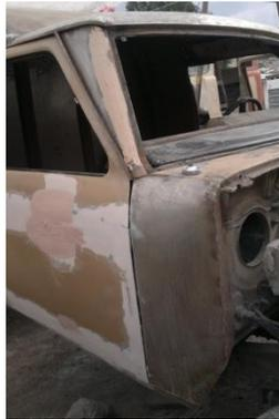
**Figura 4. 33 Implementación laterales de la cabina**
