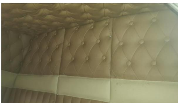
**Figura 4. 64 Tapizado del interior de la carrocería**
