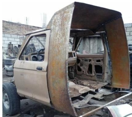
**Figura 4. 34 Soldadura de parte de la litera en la cabina**
