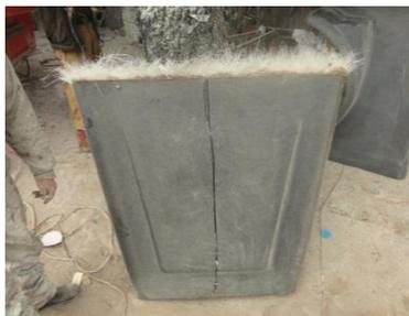
**Figura 4. 37 Molde para el capot del mini tractocamión**
