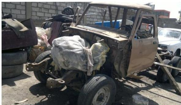
**Figura 4. 29 Modificación de la carrocería**
