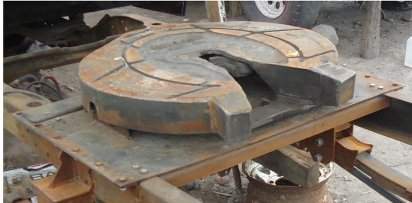
**Figura 4. 28 Montaje de la quinta rueda en el chasis**
