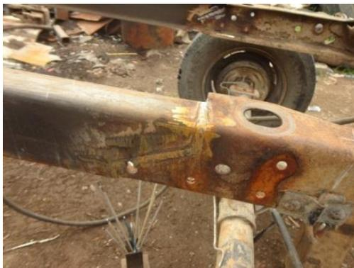
**Figura 4. 21 Punto de suelda de material adicional del bastidor**
