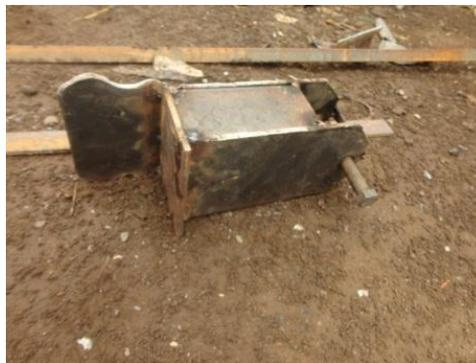
**Figura 4. 9 Soporte de suspensión posterior ensamblado**
