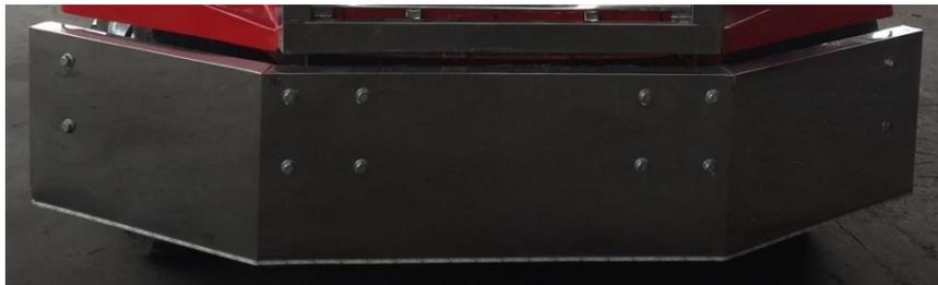
**Figura 4. 61 Guardachoque forrado con lámina de acero cromado**
