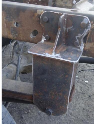
**Figura 4. 10 Soporte montado en el bastidor**
