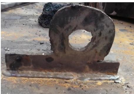
**Figura 4. 27 Acoples para sujetar la quinta rueda**
