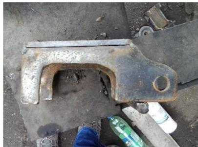
**Figura 4. 16 Montura de eje para conjunto de ballestas**
