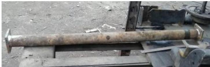
**Figura 4. 15 Eje de apoyo terminado**
