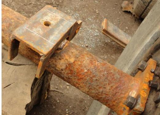
**Figura 4. 17 Montura soldada sobre el eje**
