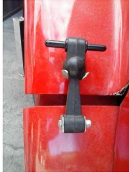
**Figura 4. 39 Gancho de seguridad del capot**
