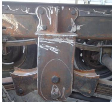
**Figura 4. 13 Balancín montado en el bastidor**
