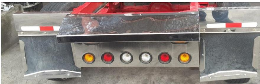
**Figura 4. 59 Bases para guarda lodos**
