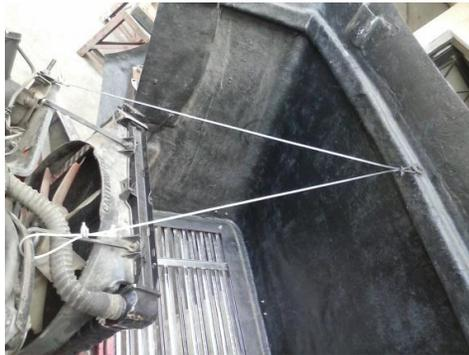
**Figura 4. 42 Alambre tensor del capot**
