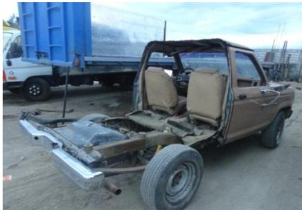
**Figura 4. 3 Corte del vehículo en la parte posterior**
