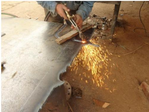
**Figura 4. 5 Corte de la plancha de acero**
