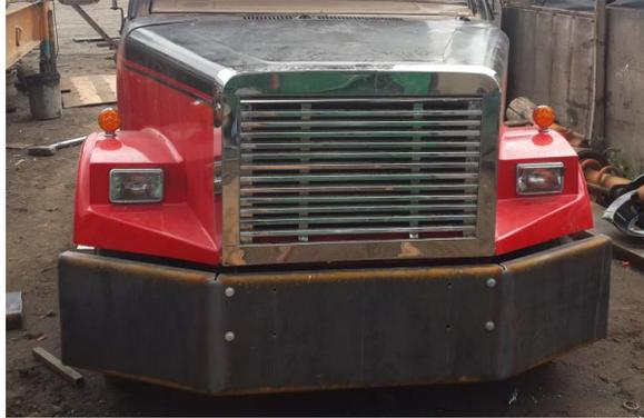
**Figura 4. 60 Guardachoque modificado y adaptado al mini tractocamión**
