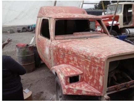
**Figura 4. 47 Carrocería lijada y masillada**
