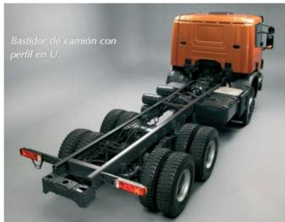
**Figura 2. 7. Bastidor de largueros longitudinales con perfil en U**
