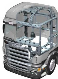
**Figura 2. 8. Carrocería de un tractocamión SCANIA**
