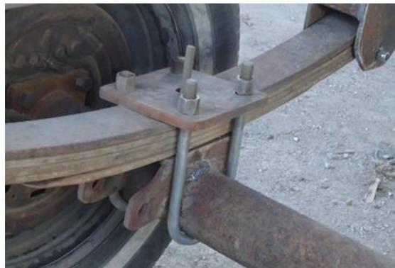
**Figura 4. 18 Montura de eje soportando la ballesta**
