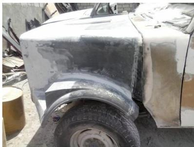
**Figura 4. 38 Capot terminado y montado**
