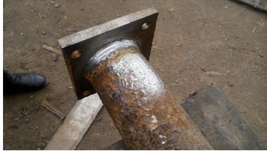
**Figura 4. 14 Base de anclaje en la rueda para el eje de apoyo**
