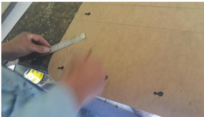
**Figura 4. 63 Trazado de moldes en cartón prensado**
