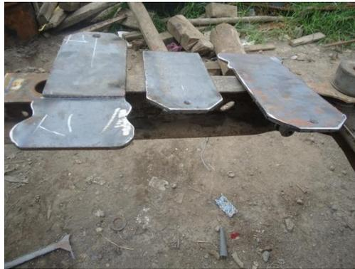
**Figura 4. 7 Piezas del soporte pulidas en sus bordes**
