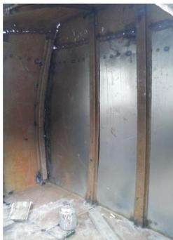
**Figura 4. 36 Soldadura de parantes en el interior de la litera**
