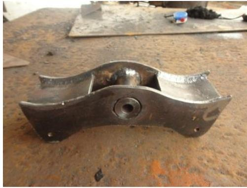
**Figura 4. 12 Balancín de la suspensión posterior ensamblado**
