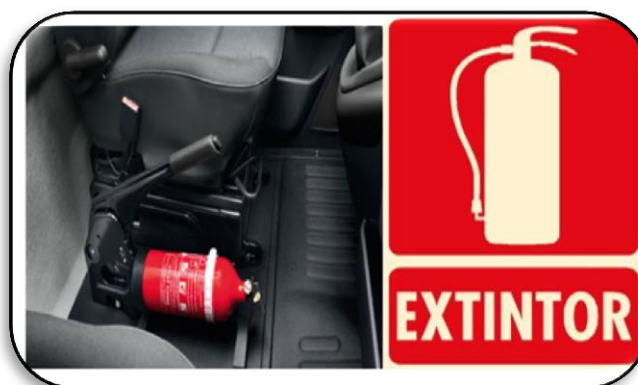
Figura 13: Ubicación de Extintores Dentro del Bus y de la Señalización del Mismo.
