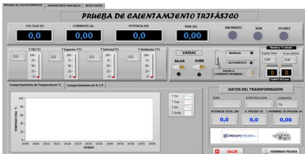
Figura 4.5. (b) Panel frontal para prueba trifásica.
