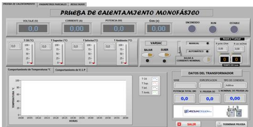
Figura 4.5. (a) Panel frontal para prueba monofásica
