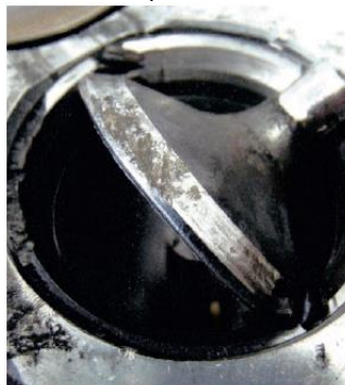
Fig. 1 Válvula arrancada en la zona del platillo de válvula
