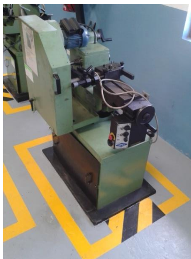
Gráfico No. 97: Rectificadora de frenos discos y tambores de frenos COMEC TR450.
