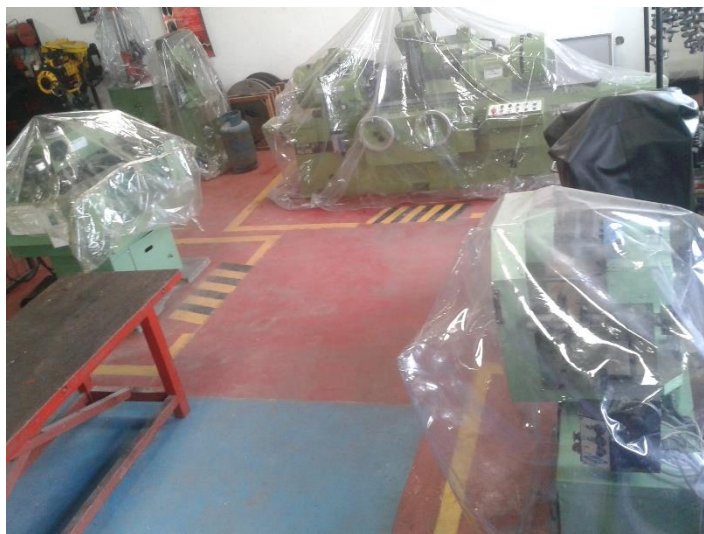
Gráfico No. 39: Ausencia de vía de circulación.
