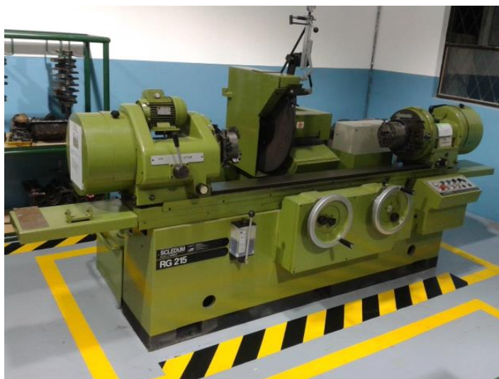
Gráfico No. 90: Rectificadora de cigüeñales SCLEDUM RG 215.
