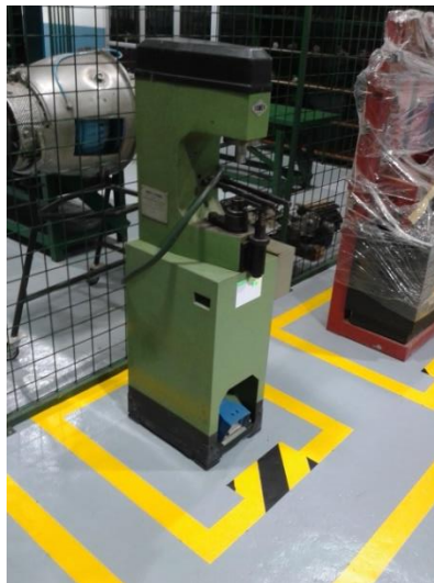
Gráfico No. 92: Remachadora de zapatas COMEC – ITALY MOD CC 300.
