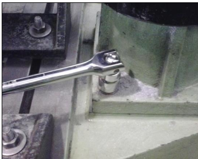
Gráfico No. 63: revisión de elementos flojos.
