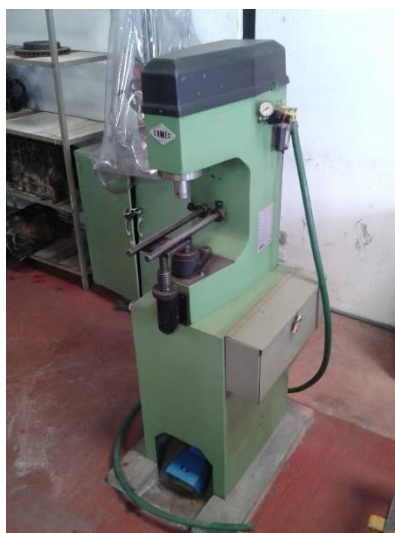
Gráfico No. 25: Ubicación incorrecta COMEC CC300.
