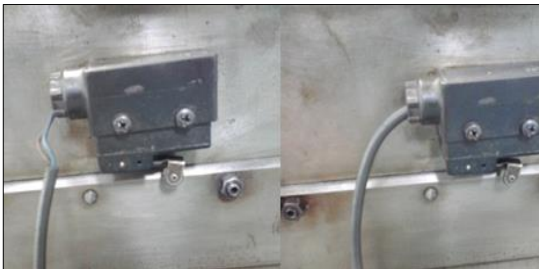
Gráfico No. 109: cables sin cubierta aislante.
