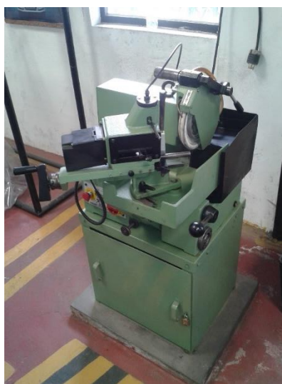
Gráfico No. 8: Rectificadora de Válvulas COMEC PORDENONE – ITALY RV 516.
