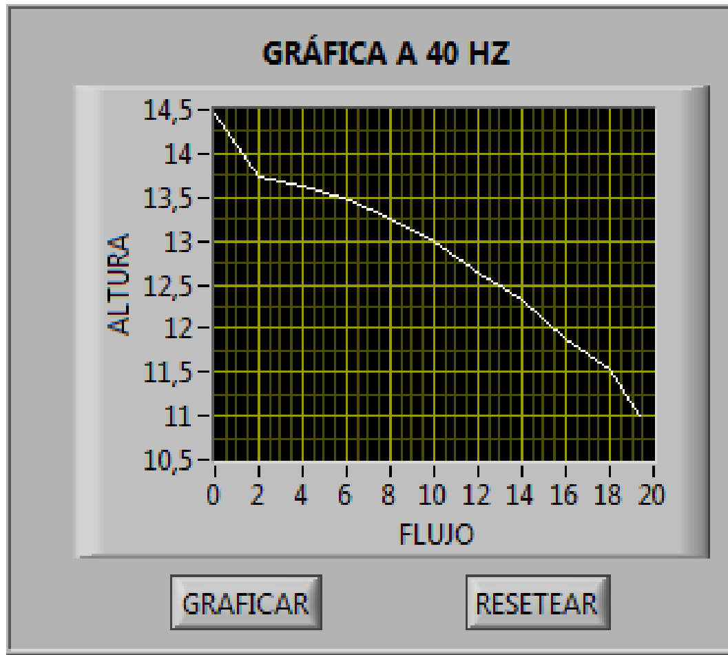
Figura 3.15: Curva obtenida de la bomba a 40hz.
