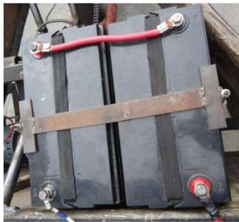
Ilustración 14 Instalación de baterías y cableado de alta.
