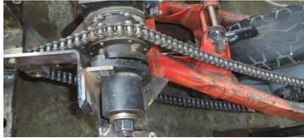
Ilustración 12 Instalación de cadena de transmisión.
