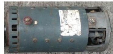
Ilustración 3 Motor DC 7.5KW
