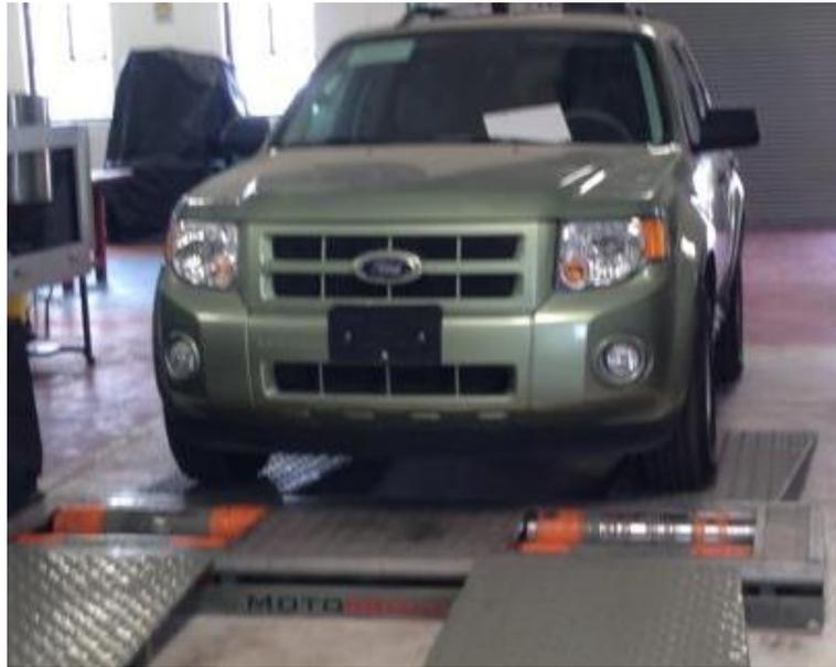
Figura 3.4. Riesgo de atropello o golpe en el dinamómetro
