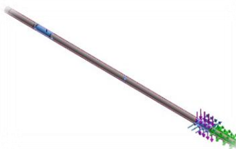
Figura No. 16: Fuerza normal que actúa sobre el eje, -9673.3 (N)
