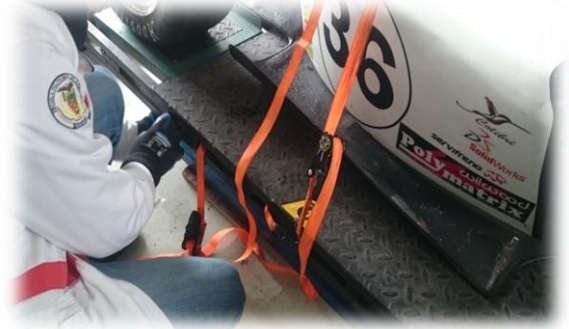
Figura No. 35: Sujeción del vehículo sobre el banco de pruebas Elaborado por: Pozo E. y Puma D.
