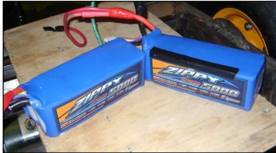
Figura 24. Baterías LiPo 22.2 V, 5000mAh
