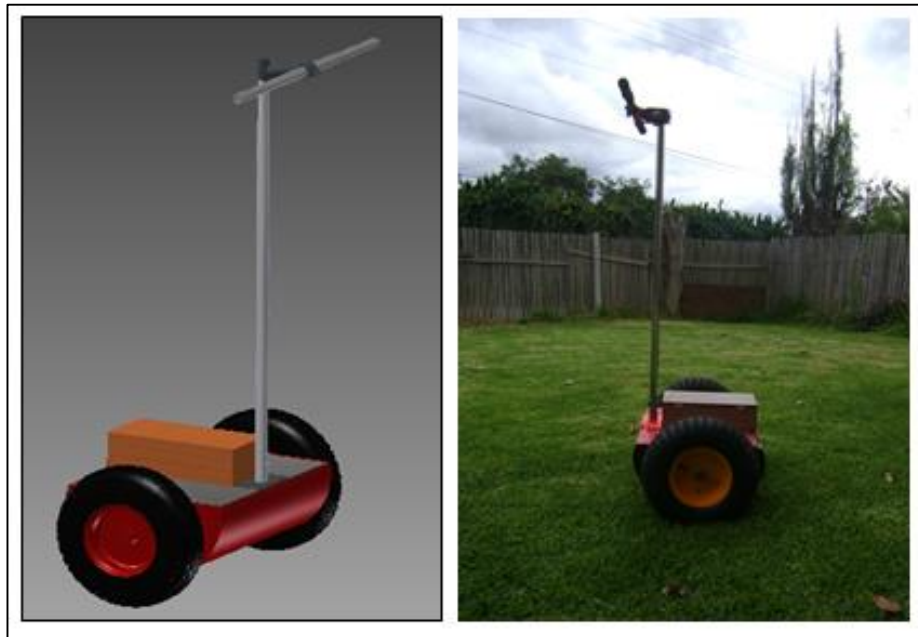
Figura 99. Proyecto VEAP diseño en Autodesk Inventor y vehículo real
