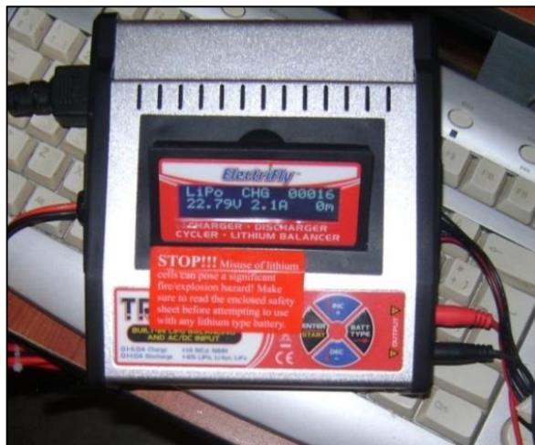
Figura 89. Condiciones iniciales de carga
