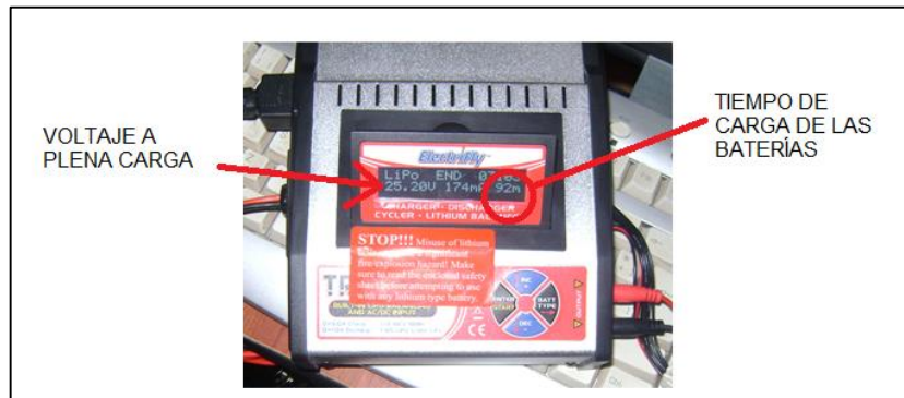
Figura 90. Tiempo requerido para la carga de baterías
