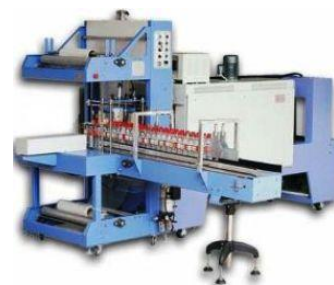
Figura 3. Empacadora de envases plásticos. Fuente: http://www.astimec.net/empacadora-termoencogible.html
