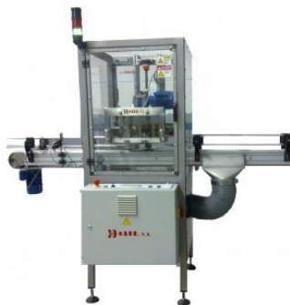
Figura 1. Cortadora de cúpula sobrante de envases plásticos. Fuente: http://www.maer.es/en/cortadoras-de-botellas-sb330/
