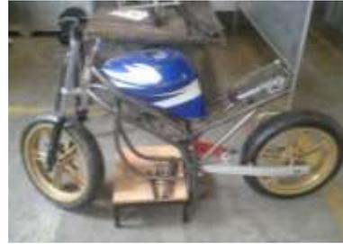
Figura 9. Ensamble del sub-bastidor (soporte del asiento)
