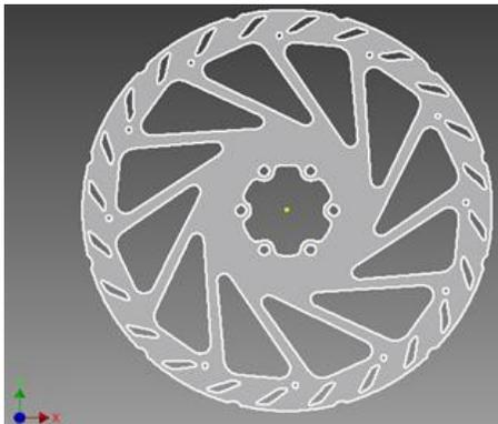
**Figura 12. Geometría del disco de freno.**
