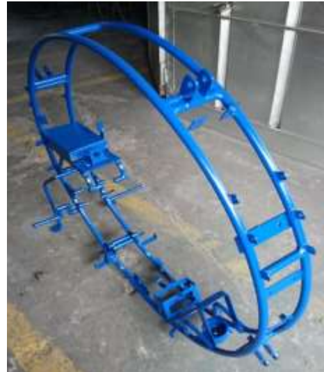
Figura 19: Bastidor, acabado con pintura electrostática.
