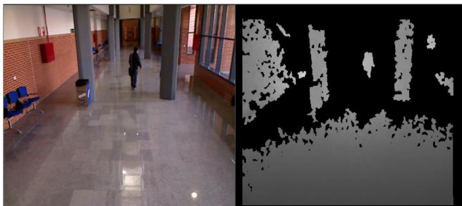
Figura 8: Efecto de distancias grandes en el Kinect
