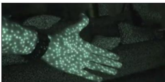
Figura 5: Proyección del patrón infrarrojo
