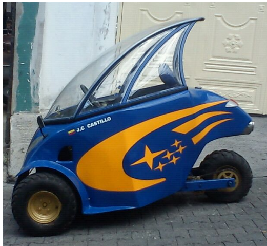
Figura 12. Carrocería de fibra de vidrio pintada al horno
