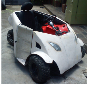
Figura 11. Masillado de la carrocería de fibra de vidrio
