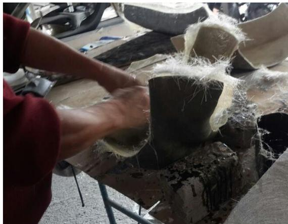
**Figura 87. Aplicación de la manta de fibra de vidrio sobre el molde**
