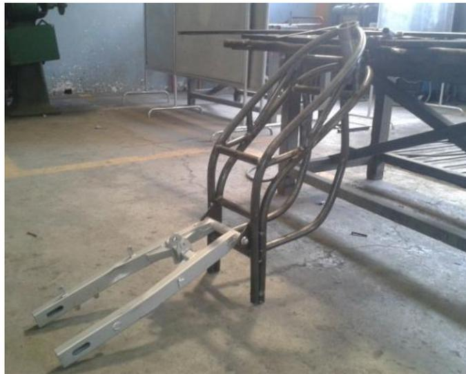
**Figura 76. Vista previa de la unión basculante-bastidor**
