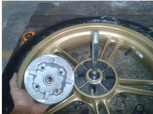
**Figura 79. Cauchos insertados en la llanta**
