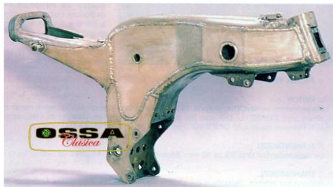
**Figura 19. Chasis monocasco Ossa 250.**
