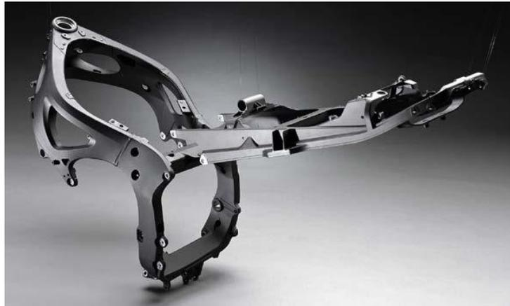
**Figura 22. Unión de chasis y el subchasis.**
