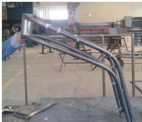
**Figura 69. Soldadura de los cuatro tubos doblados**
