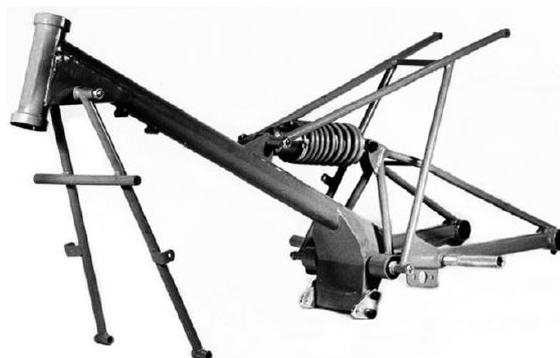
**Figura 17. Chasis espina central con bifurcación en la parte trasera.**
