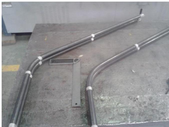
**Figura 59. Control de las dimensiones y de la recuperación elástica**
