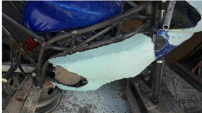
**Figura 91. Panel lateral en fibra de vidrio antes de lijar y pulir**
