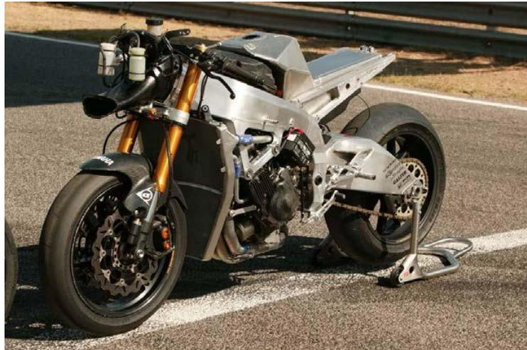
**Figura 23. Chasis doble viga. Laglisse Moto.**
