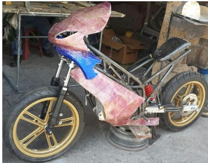
**Figura 93. Ensamble del carenado previo a recibir pintura**
