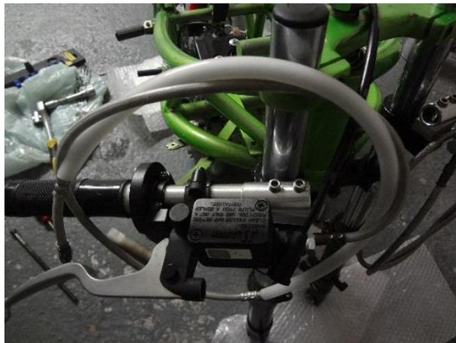
**Figura 48. Mangueras hidráulicas**
