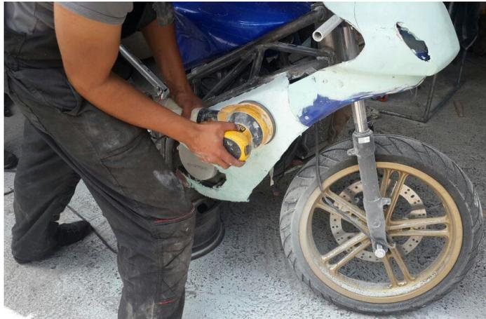
**Figura 92. Lijado y pulido del carenado**
