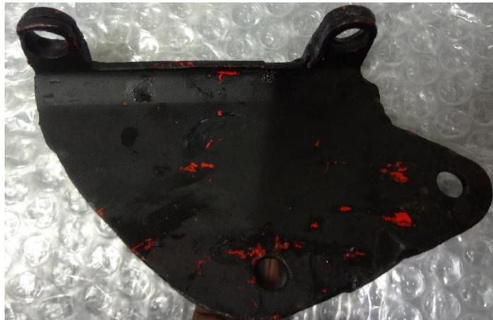
**Figura 51. Soporte delantero del freno**
