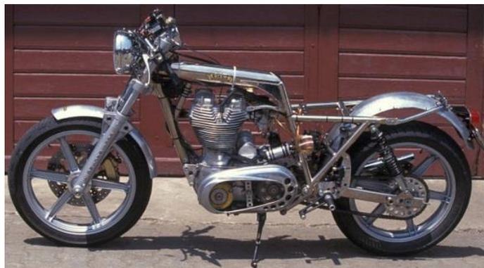
**Figura 13. Chasis con motor como elemento estructural.**
