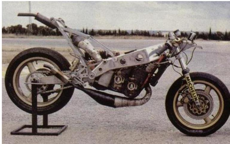
**Figura 21. Chasis doble viga "Deltabox".**
