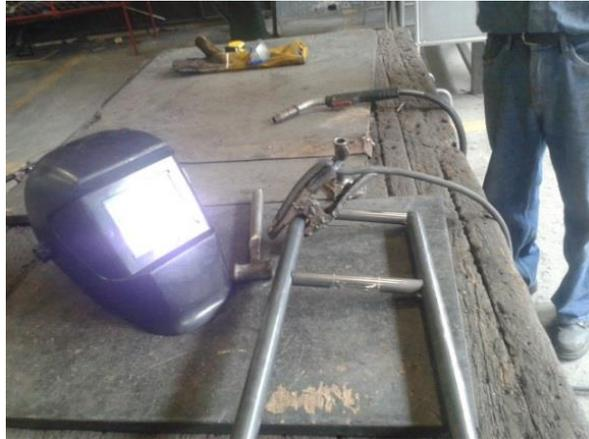
**Figura 81. Soldado del sub-bastidor**
