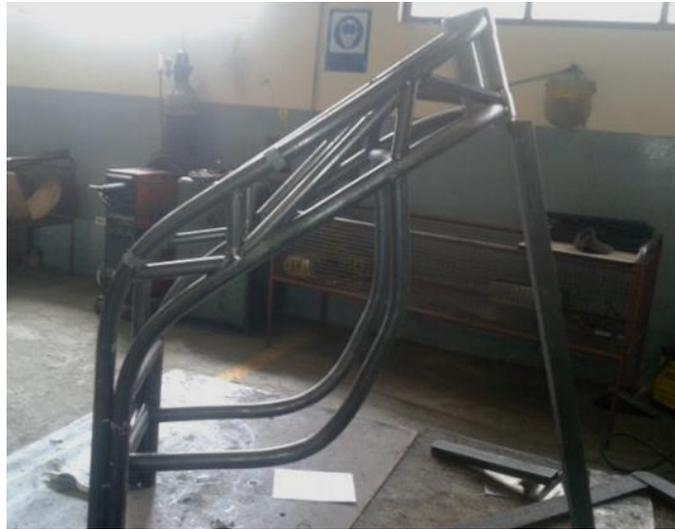
**Figura 74. Ubicación de tubos de soporte del motor (doble cuna)**
