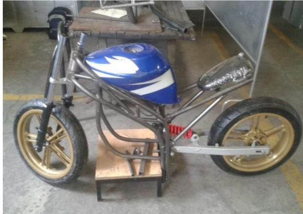
**Figura 83. Ensamble del sub-bastidor (soporte del asiento)**
