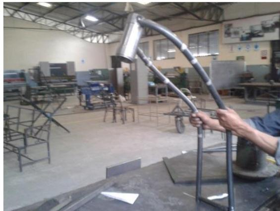
**Figura 65. Ubicación del eje de dirección con el ángulo caster**
