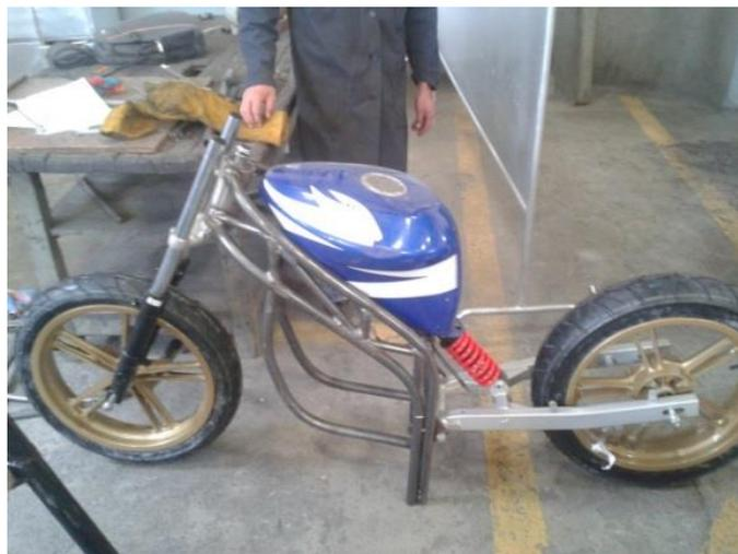
**Figura 82. Montaje del amortiguador en el bastidor y basculante**
