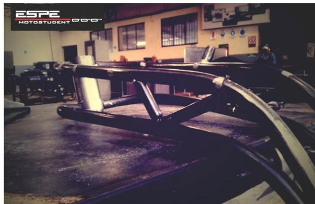
**Figura 71. Triangulación completa del bastidor**
