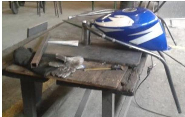
**Figura 66. Ubicación del tercer tubo y verificación del ángulo**
