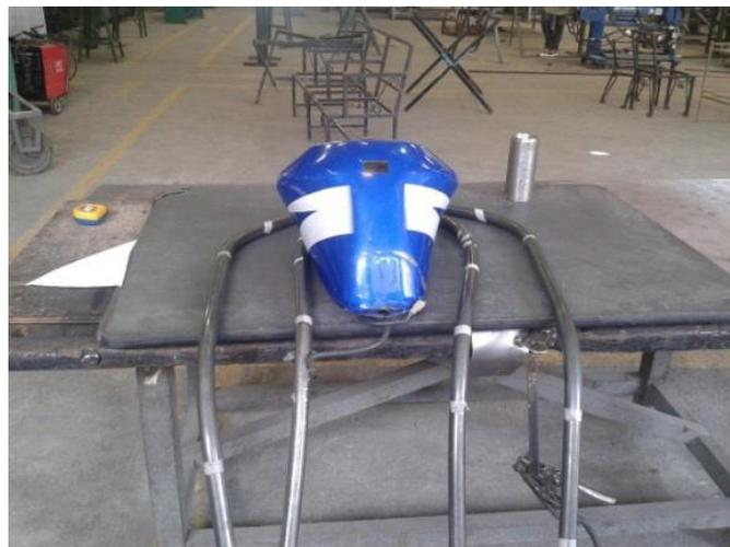
**Figura 61. Vista previa del tanque de combustible con los tubos doblados**
