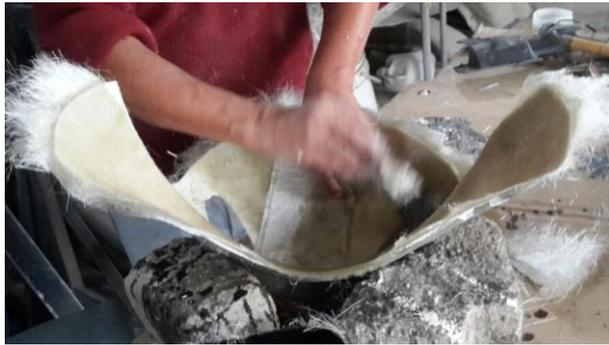
**Figura 88. Aplicación de la mezcla de gel-coat sobre la fibra de vidrio**
