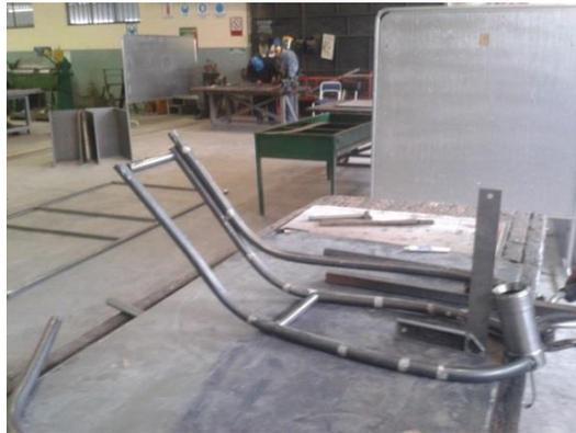
**Figura 67. Uso de escuadra para el control geométrico**
