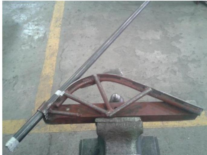
**Figura 56. Posición del tubo en la matriz semicircular**
