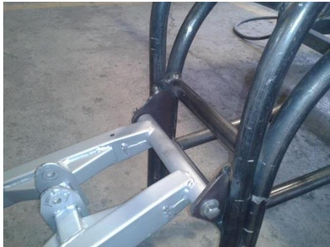
**Figura 75. Ubicación de los soportes del basculante**
