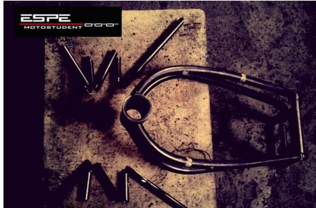
**Figura 70. Preparación de tubos para triangulación**
