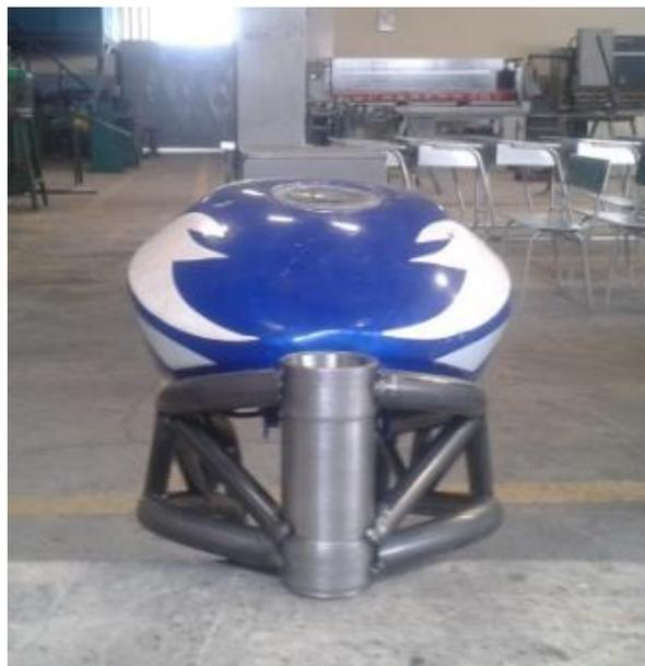
**Figura 73. Vista frontal del bastidor con el tanque de combustible**
