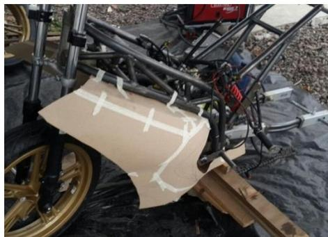
**Figura 86. Vista previa del panel lateral del carenado**
