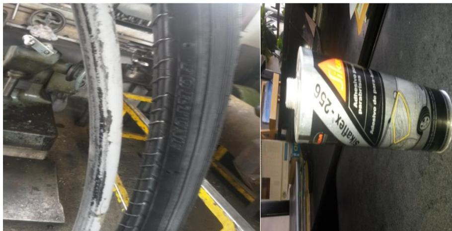
**Figura 3. 6: Fijación de la cubierta protectora de la rueda y recubrimiento**
