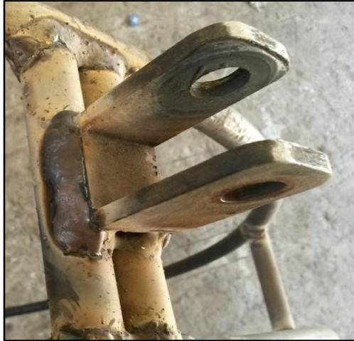
**Figura 3. 11: Soportes de los rodamientos Guías**
