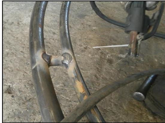
**Figura 3. 3: Terminado de suelda rueda principal (7018)**
