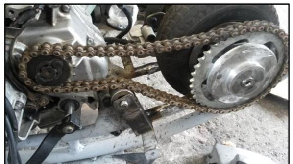
**Figura 11: Ensamble de todo el sistema de transmisión**
