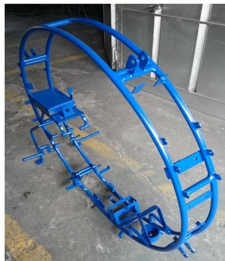
**Figura 19: Bastidor, acabado con pintura electroestática.**
