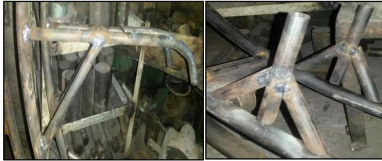
**Figura 3. 13: Soportes principales del motor**
