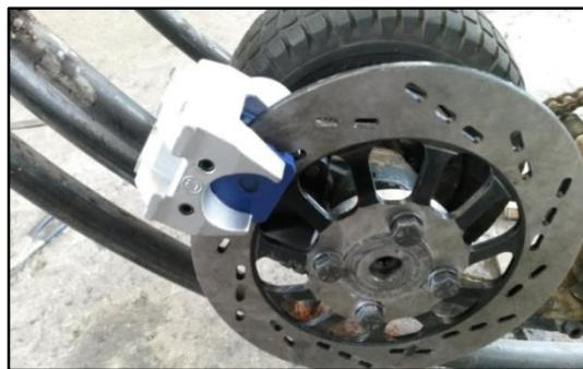
**Figura 3. 33: Mordaza de freno y disco ensamblado**
