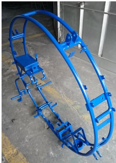
**Figura 3. 41: Bastidor, acabado con pintura electrostática.**
