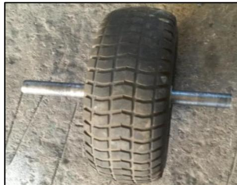
**Figura 3. 20: Rueda de transmisión y eje**
