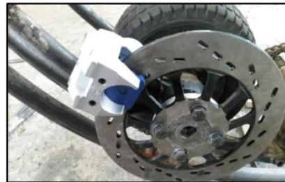
**Figura 18: Mordaza de freno y disco ensamblado**
