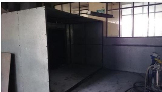
**Figura 3. 39: Cámara de aplicación de pintura electrostática.**
