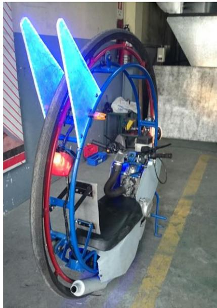
**Figura 3. 43: Monowheel, acabados terminados.**
