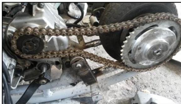
**Figura 3. 18: Ensamble de todo el sistema de transmisión**
