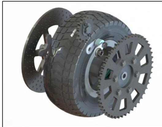
**Figura 2. 29: Modelado del sistema de transmisión de cadena y catarina.**
