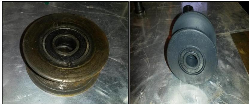
**Figura 3. 12: Rodamientos guías**
