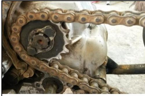
**Figura 3. 17: Piñón de salida movimiento del motor (catarina motriz)**
