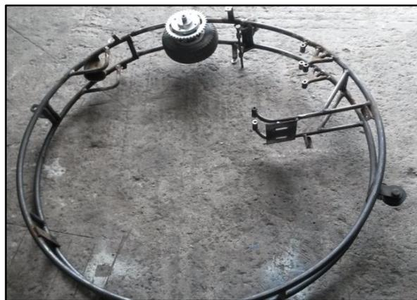
**Figura 3. 10: Bastidor incorporado la rueda de transmisión**
