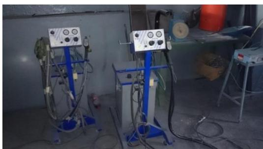
**Figura 3. 38: Equipo para pintura electrostática.**
