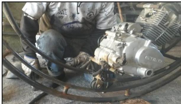
**Figura 3. 24: Montaje del motor en el bastidor**
