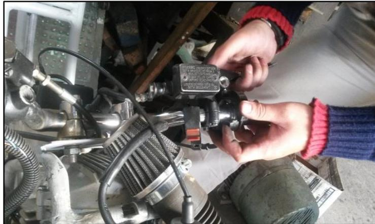
**Figura 3. 27: Bomba de freno hidráulica**
