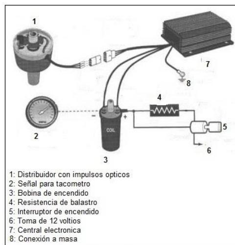
**Figura 2.29: Partes del sistema de encendido óptico**
