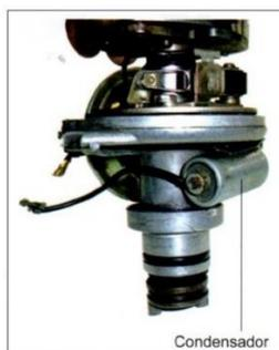
**Figura 2.7: Condensador**
