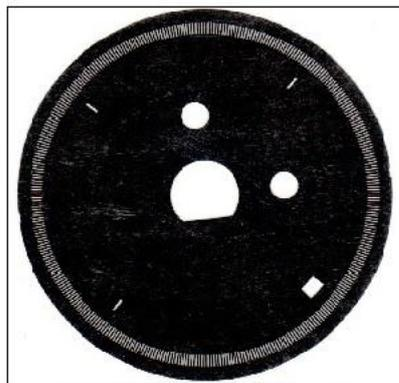
**Figura 2.28: Lámina ranurada del sensor óptico**
