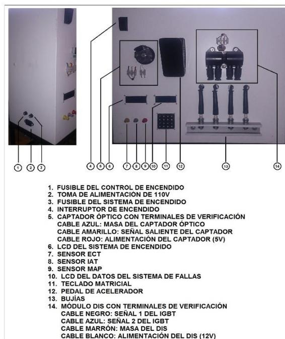
En el gráfico anterior se puede ver las partes del simulador de encendido óptico las cuales se deben analizar antes de proceder con cualquier prueba o medición en el mismo.
