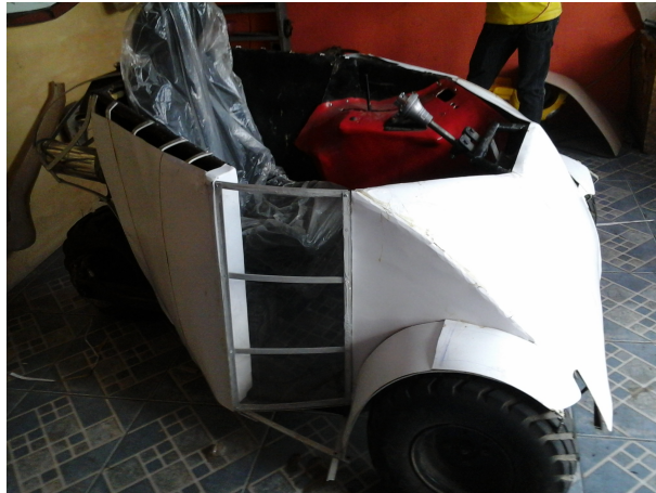
Figura 4-24. Diseño del vehículo con cartón
