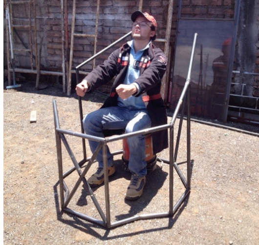
Figura 4-3. Dimensionamiento del bastidor con un ocupante.
