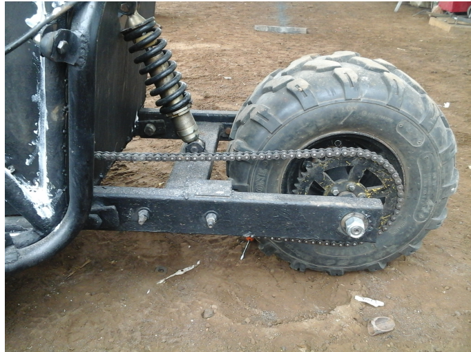
Figura 4-14. Segundo eje de transmisión, acoplado a la rueda Fuente. Grupo Investigador.
