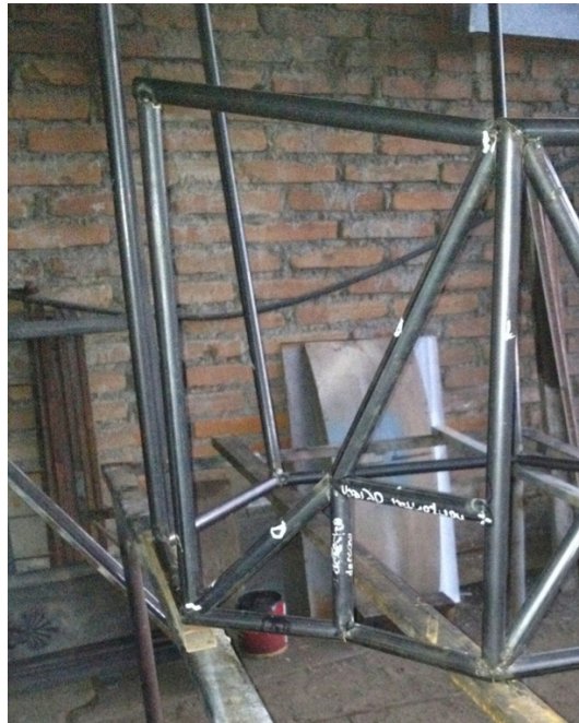
Figura 4-6. Triangulación de las bases de la suspensión en el bastidor Fuente. Grupo Investigador.
