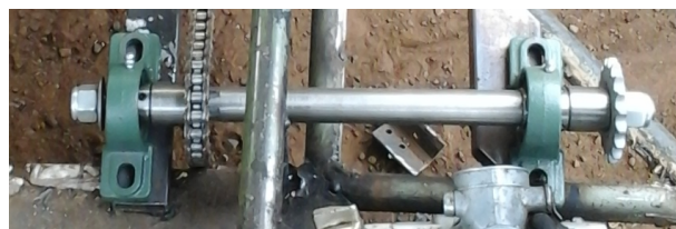
Figura 4-15. Eje delantero de transmisión. Fuente. Grupo Investigador.
