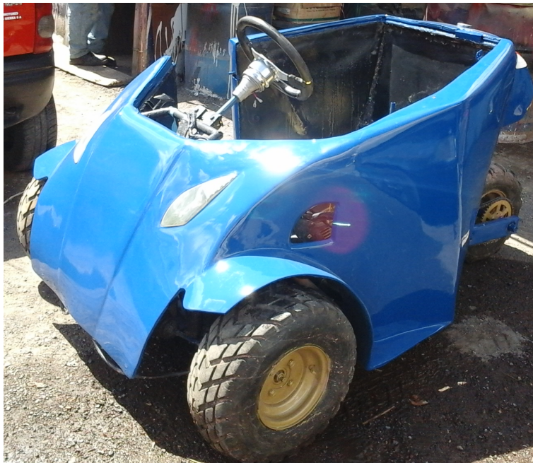
Figura 4-35. Carrocería de fibra de vidrio pintada al horno
