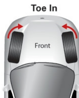
Figura 2-18. Ángulo de convergencia (toe-in)
