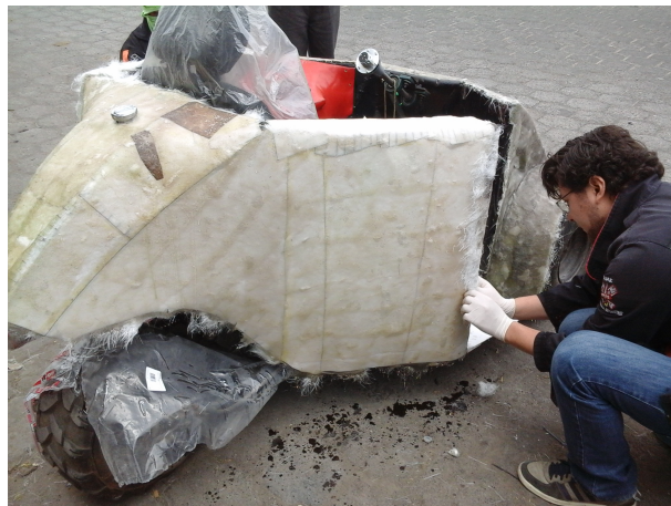
Figura 4-27. Colocación de fibra de vidrio
