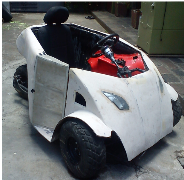
Figura 4-31. Masillado de la carrocería de fibra de vidrio
