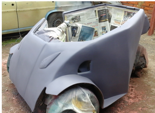
Figura 4-33. Fondo en la carrocería de fibra de vidrio
