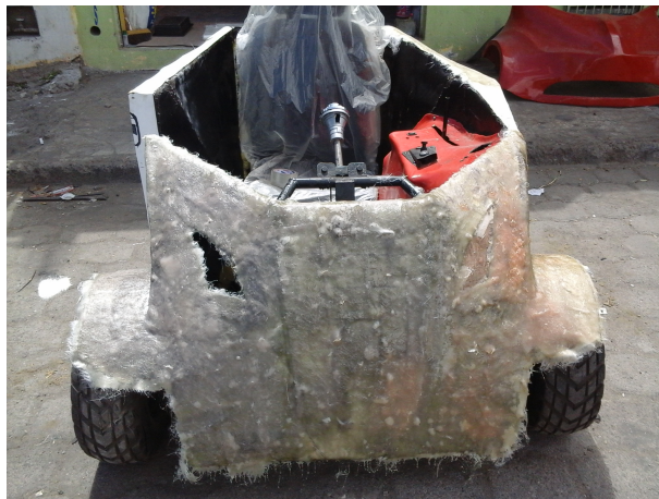
Figura 4-29. Endurecimiento de la fibra de vidrio, vista frontal
