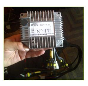
Es el elemento electrónico más importante del sistema electrónico ya que gobierna todos estos sistemas; la inyección electrónica, sistemas de encendido, transmisión (control de tracción), suspensión activa, frenos ABS, alumbrado, accesorios, entre otros.
