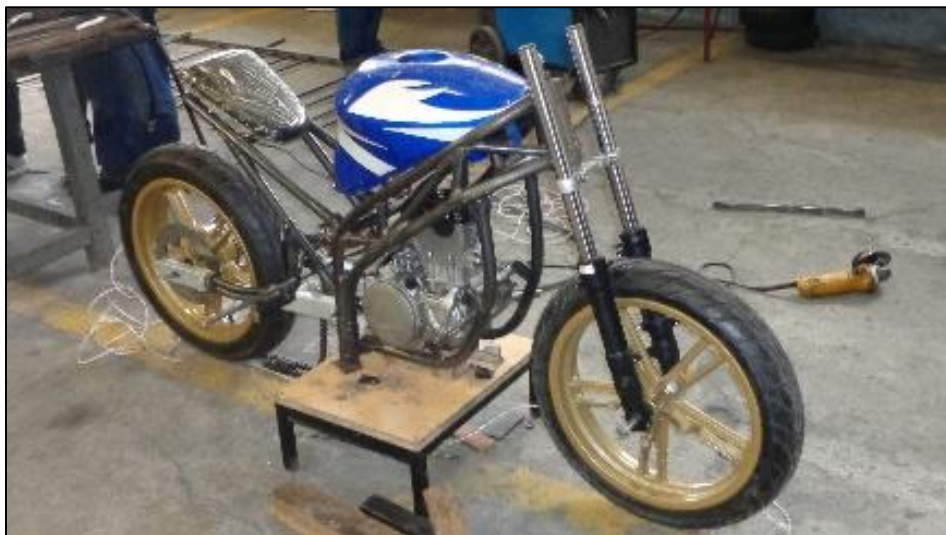
Fig. 4.3 Colocación del Tanque y Asiento Fuente: Loor, E. & Mendes, G.
