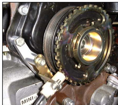
Fig. 2.35: Ubicación en el sensor CKP Fuente: Loor, E. & Mendes, G.
