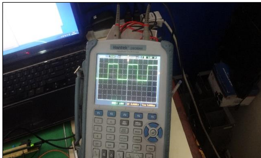
Fig. 3.25 Señal del CKP (50% de aumento) Fuente: Loor, E. & Mendes, G.
