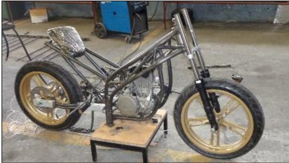
Fig. 4.2 Colocación del Motor Fuente: Loor, E. & Mendes, G.
