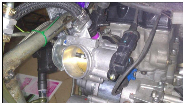
Fig. 2.29: Ubicación del sensor TPS Fuente: Loor, E. & Mendes, G.
