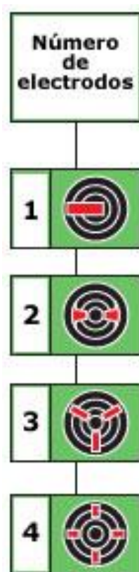
Fig. 2.23: Forma de Electroodos Fuente: www.aficionadosalamecanica.net
