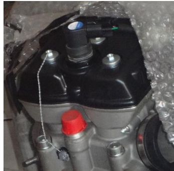
Fig. 2.8: Ubicación de la Bobina Fuente: Loor, E. & Mendes, G.
