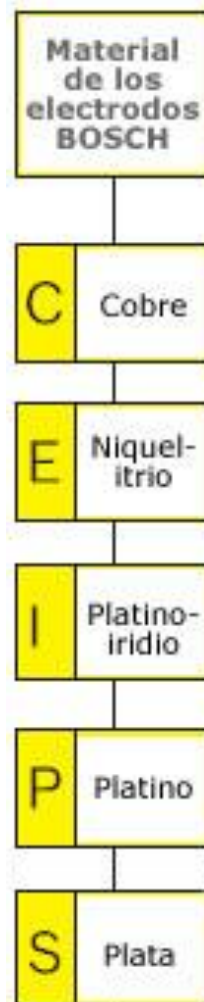
Fig. 2.24: Materiales de Electrodos (Bosch) Fuente: www.aficionadosalamecanica.net
