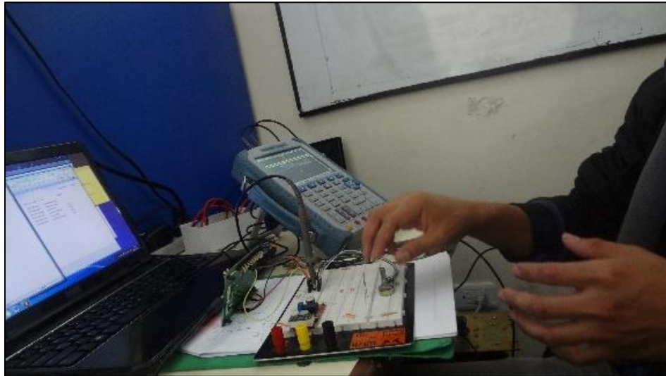
Fig. 3.18 Enviando la programación a la Tarjeta Electrónica STM32F4 Discovery
