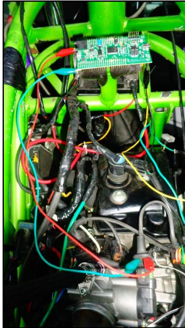
Fig. 4.14 Conexión en el sensor TPS Fuente: Loor, E. & Mendes, G.
