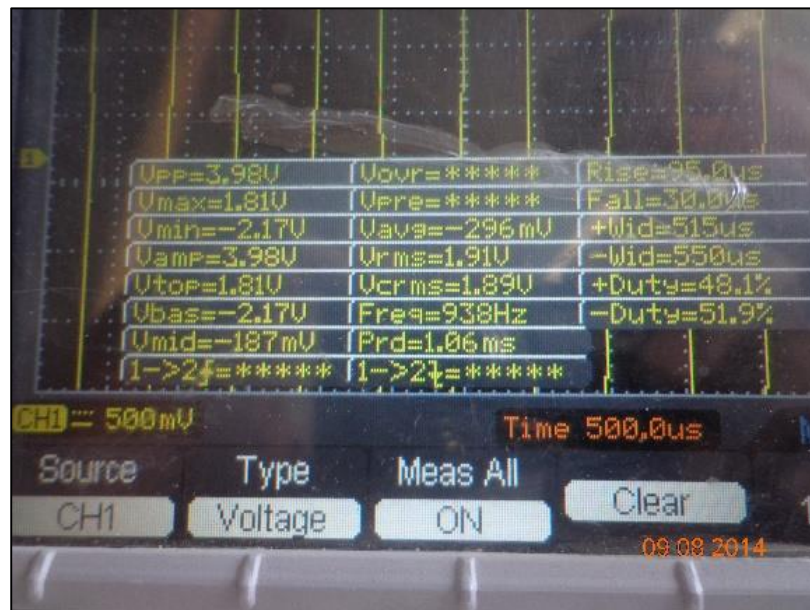
Fig. 3.19 Datos de la gráfica del sensor CKP Fuente: Loor, E. & Mendes, G.
