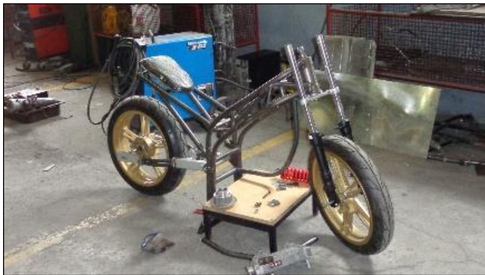
Fig. 4.1 Construcción del Chasis Fuente: Loor, E. & Mendes, G.
