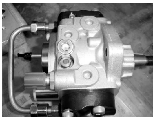
Figura 4.64. Instalación del tapón del filtro.
