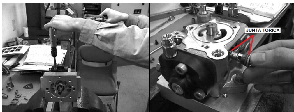
Figura 4.60. Instalación de la válvula de regulación.
