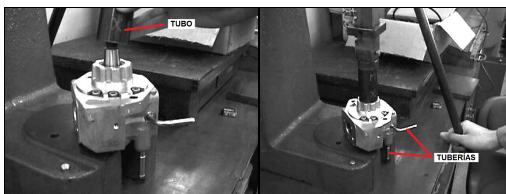
Figura 4.50. Ajuste del conjunto de la cubierta en la prensa.
