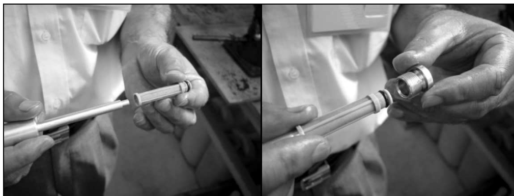
Figura 4.62. Instalación del conjunto secundario del filtro.
