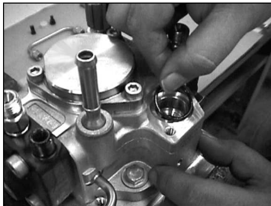
Figura 4.13. Extracción de la junta tórica. Elaborado por: Jaya– Tugumbango.
