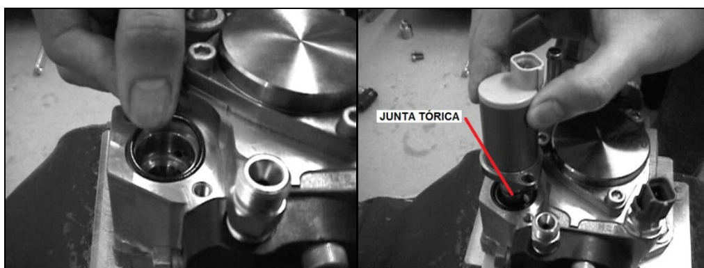
Figura 4.72. Instalación de la junta tórica.
