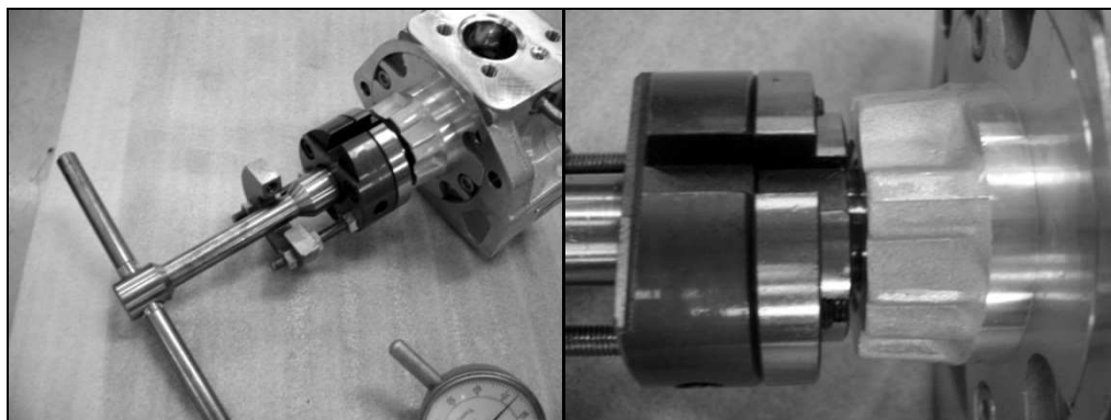
Figura 4.43. Instalación del medidor de holgura.
