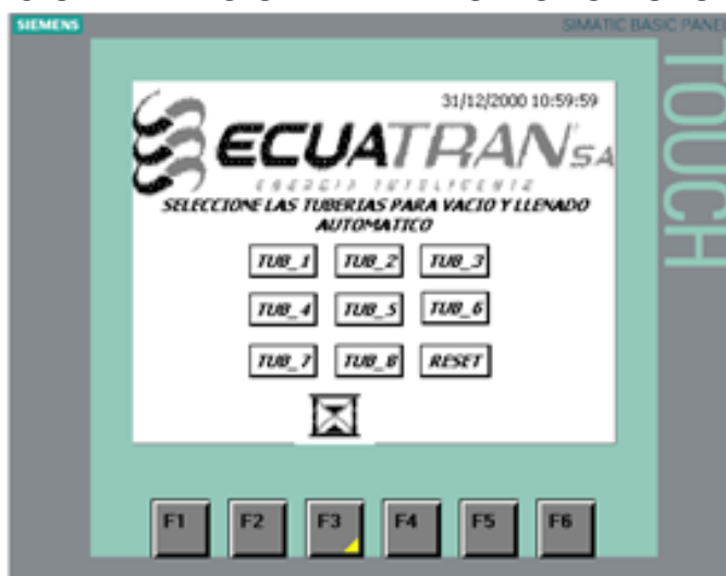
Figura 10. Ventana de selección de tuberías para vacío y llenado. Elaborado por: Orozco Ruíz, Héctor Hugo
