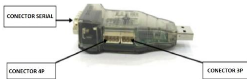
Figura 2.- Interfaz USB2Dynamixel y sus puertos de conexión
