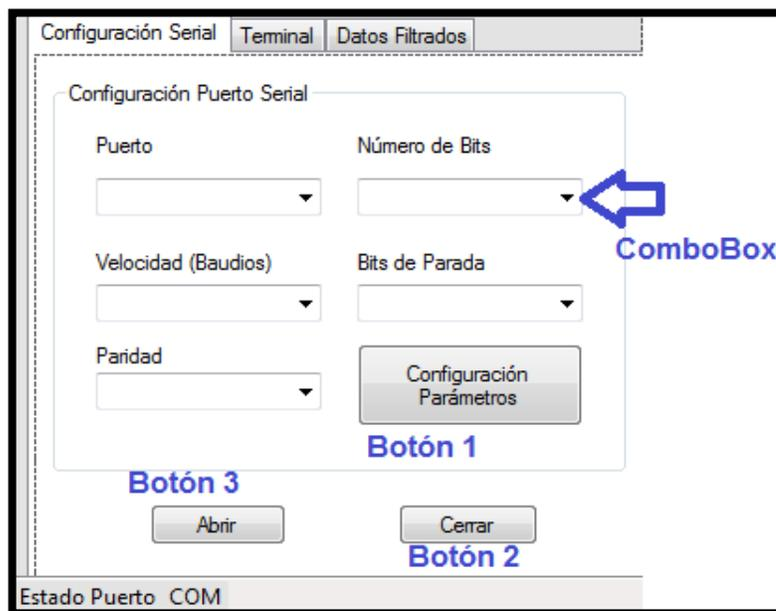
**Figura 2.5: Interfaz gráfica para la configuración del puerto serial**
