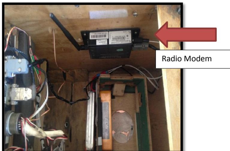
**Figura 3.2: Instalación del radio modem en el UAV-0**
