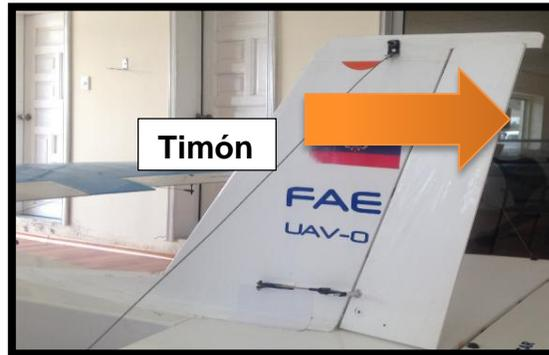
**Figura 3.16: Comprobación del servomotor del timón**
