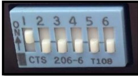
**Figura 2.10: Configuración DIP Switch RS-232**
