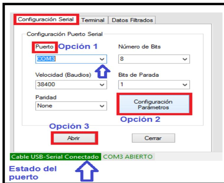
**Figura 3.9: Configuración del puerto serial**
