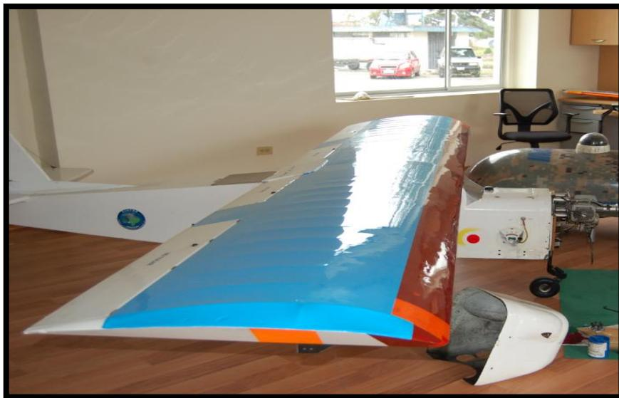
**Figura 1.7: Estructura del ala del UAV-0 Pelicano**
