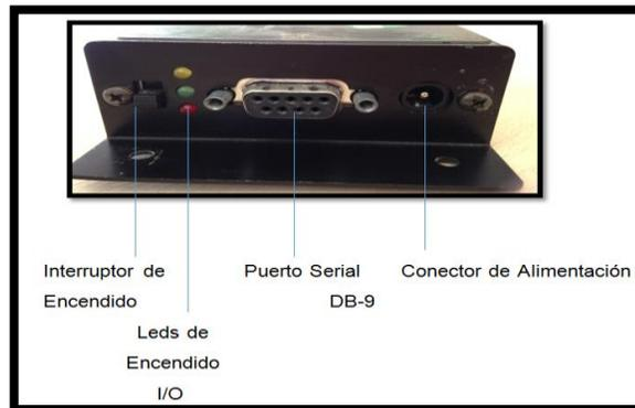
**Figura 2.7: Vista frontal del radio módem**
