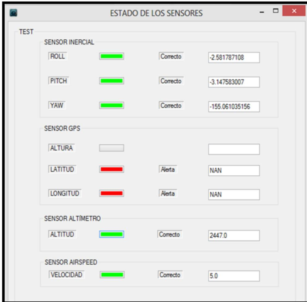
**Figura 3.21: Estado de los sensores del UAV-0**
