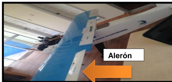
**Figura 3.15: Comprobación de los servomotores de los alerones**
