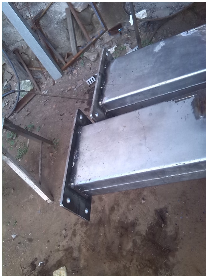
FIGURA 3.31. Base principal soldada con la placa de sujeción. ELABORADO POR: Arroba, P. y López, J.
