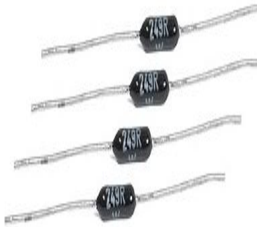
Figura 2.3: Resistencias de 249 Ohm.
