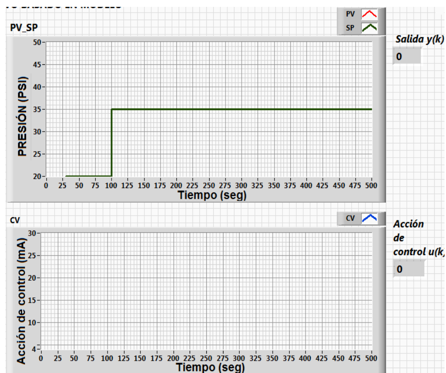
Figura 2.37: Respuesta del MPC cuando el H_c > H_p .
