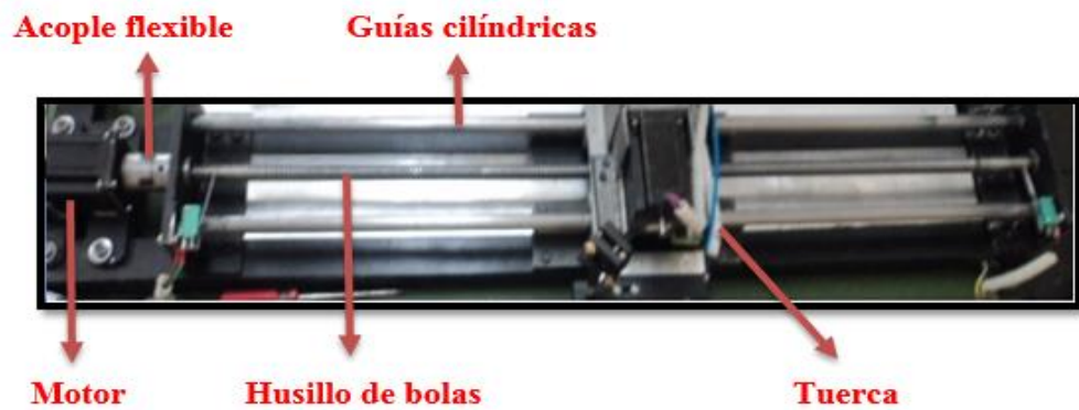
Figura 4.2 Mecanismo desplazamiento del eje "Y"
