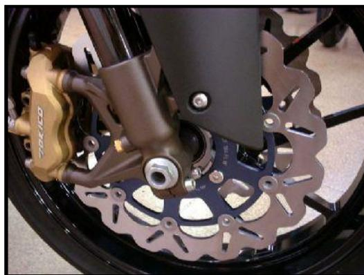
**Figura 1. 2: Sistema de Frenos**
