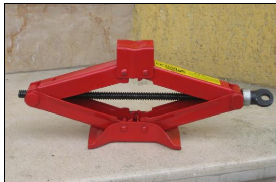
Figura 5. 2 Elevador mecánico tipo lagarto
