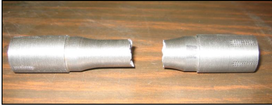
Figura 6. 29 Fotografía de la probeta luego del ensayo de tracción
