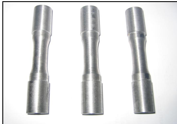
Figura 6. 26 Probetas de Hierro Fundido
