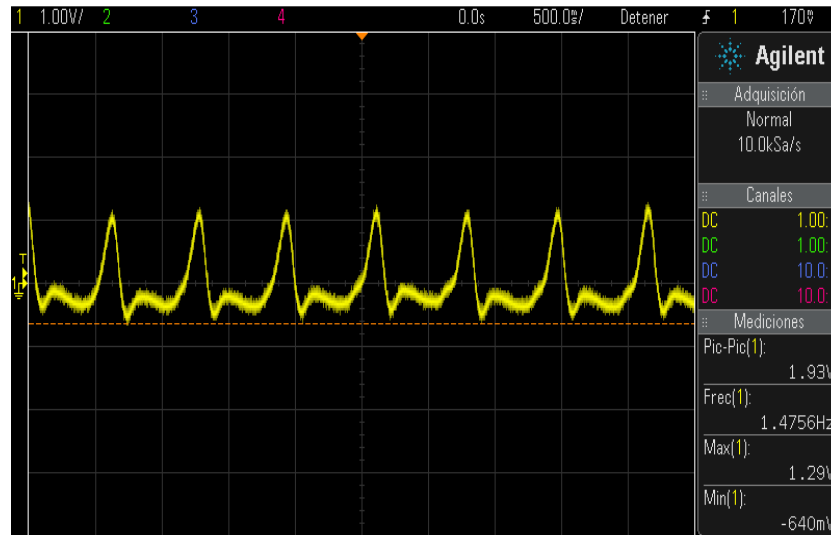
Figura 3.8. Forma de onda a la salida del diferenciador.
