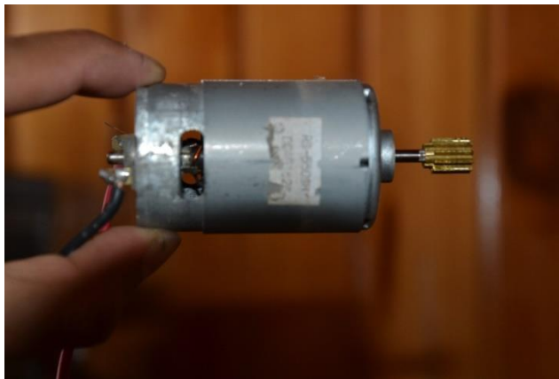
Figura 2.69 Motor DC, extraído de una moto para niños.
