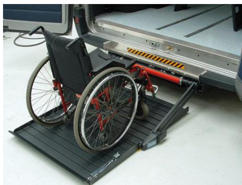
Figura 1.7 Plataforma para acceder a medios de transporte
