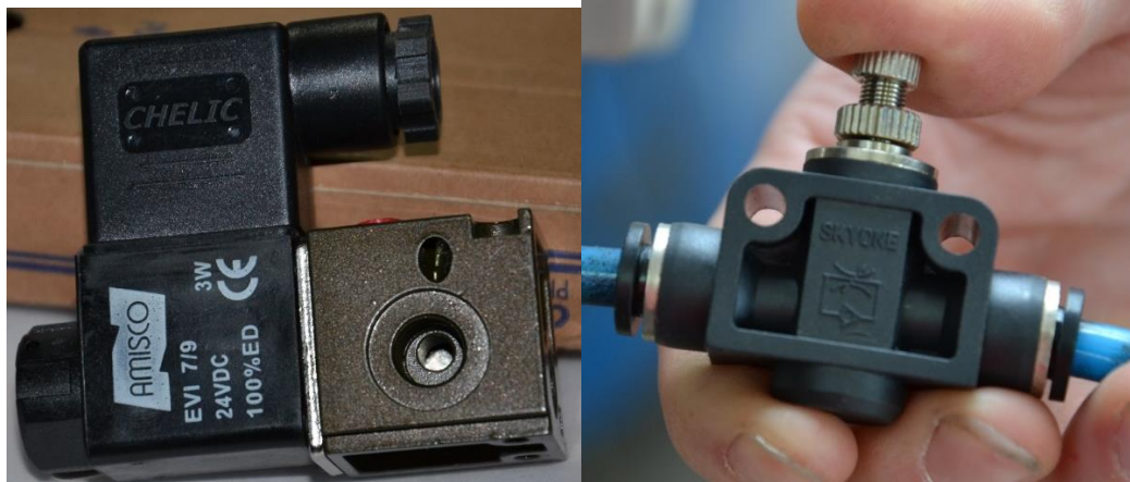
Figura 3.16 Electroválvula 3/2 y válvula estranguladora en una vía
