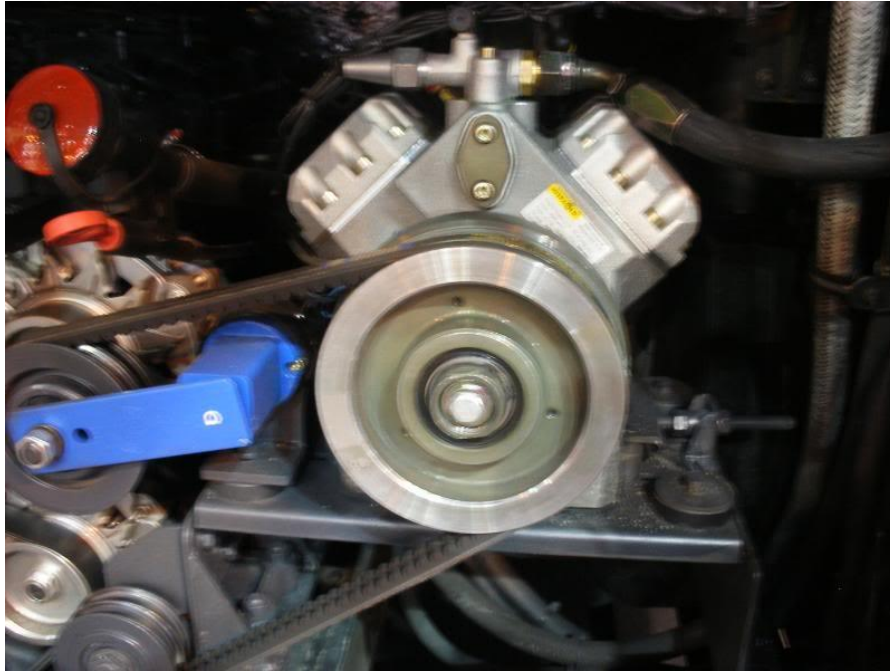
Figura 2.30 Ejemplo de la instalación al cigüeñal del vehículo
