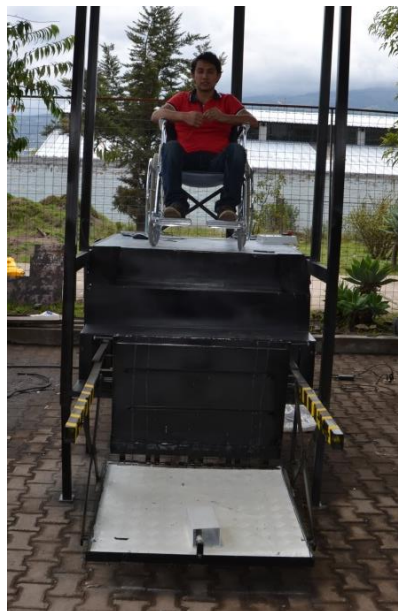
Figura 3.51 Plataforma descendiendo para abrir la extensión
