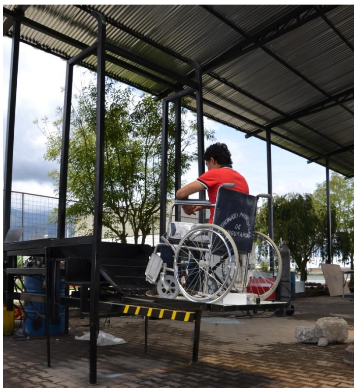
Figura 3.44 Plataforma elevando al usuario a la altura del piso del bus
