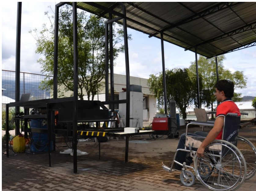
Figura 3.36 Plataforma saliendo de la contrahuella de la segunda grada
