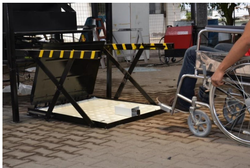
Figura 3.39 Plataforma liberando la Rampa
