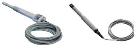
Figura 1.3: Sensores de humedad relativa y temperatura HMP155 y HMP45X [10] y [9]
