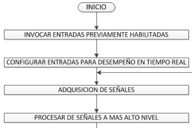
Figura 3.15: Diagrama de flujo implementado en el Modulo Real Time
