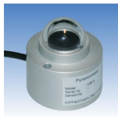
Figura 1.12: Sensor de irradiancia Kipp & Zonen CM3 [24]
