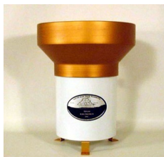
Figura 1.14: Pluviómetro marca TEXAS TR-525M-R3 [27]
