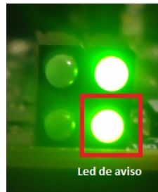
Figura A.2: Led de aviso de inicialización de la sb-RIO
