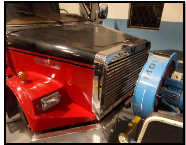
Figura 5. 5. Ubicación de ventilador del dinamómetro en el vehículo Elaborado por: López J. y Morales A.
