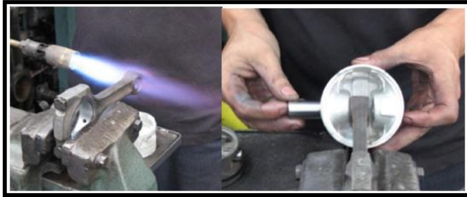
Figura 3. 29. Armado del pistón
