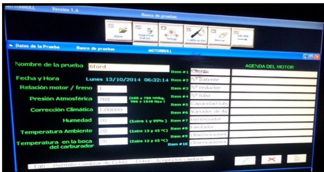
Figura 5. 2. Parámetros de calibración del dinamómetro
