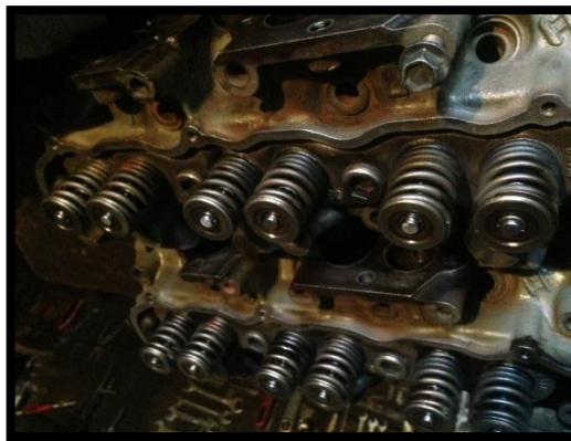
Figura 3. 8. Disposicion de los resortes de válvulas
