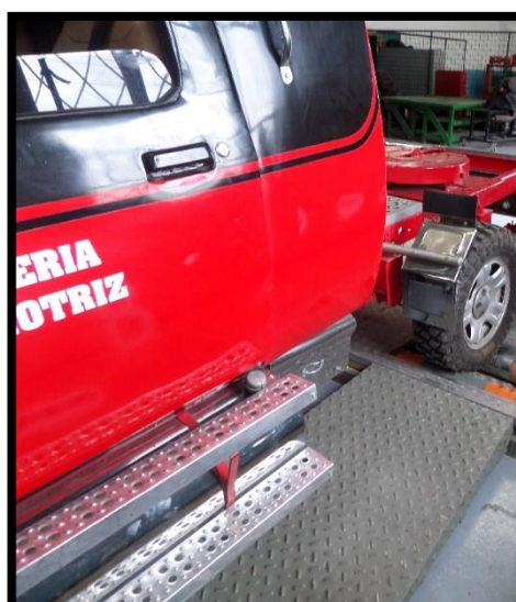
Figura 5. 3. Ubicación de las ruedas motrices en los rodillos del dinamómetro
