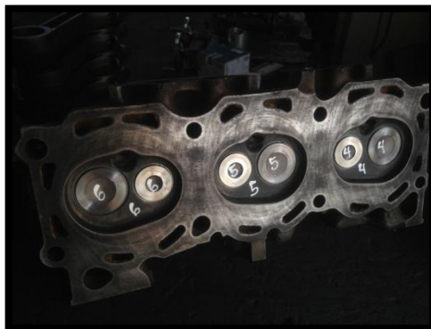
Figura 3. 5. : Montaje de las válvulas
