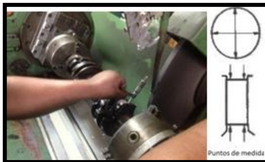
Figura 3. 21. Medida del desgaste de los muñones de apoyo
