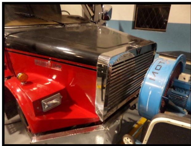
Figura 5. 5. Ubicación de ventilador del dinamómetro en el vehículo
