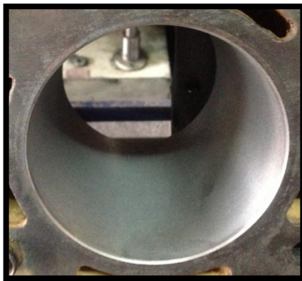
Figura 3. 19. Nuevo diámetro del cilindro rectificado
