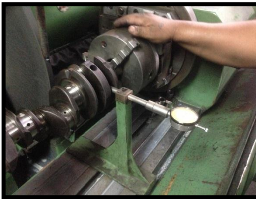
Figura 3. 23. Control del rectificado por reloj de lectura continúa
