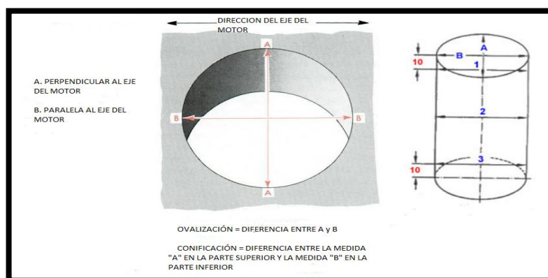
Figura 3. 12. Puntos de medida dentro del cilindro
