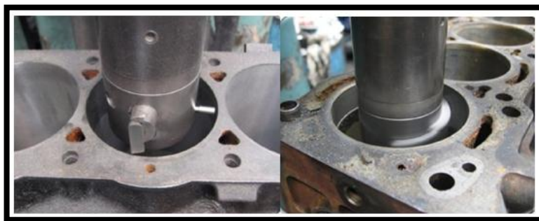
Figura 3. 13. Alesado de los cilindros
