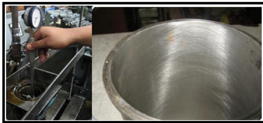
Figura 3. 15. Rugosidad y cruce del proceso de bruñido
