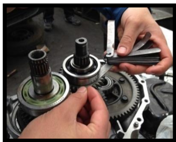
Figura 3. 32. Medición del juego entre engranes
