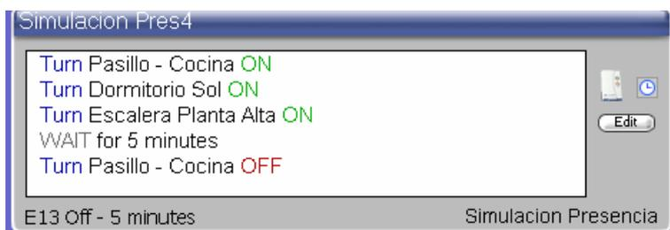
Figura 5.36. Macro 4 para simulación de Presencia
