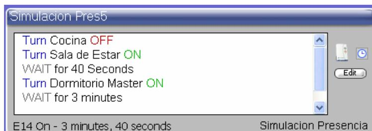
Figura 5.37. Macro 5 para simulación de Presencia
