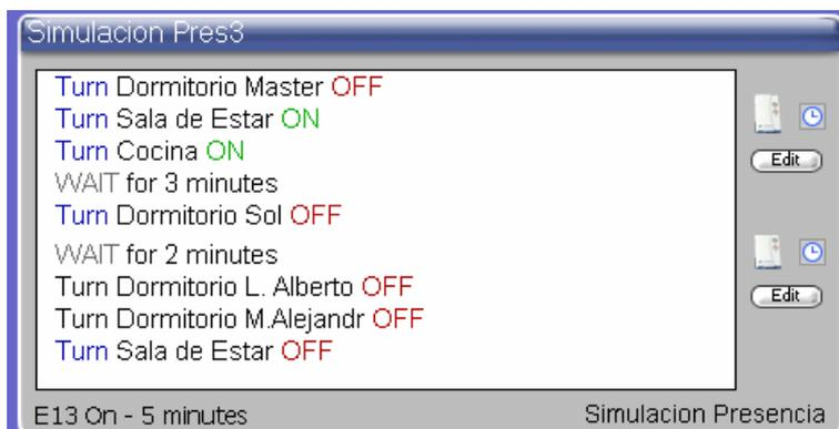
Figura 5.35. Macro 3 para simulación de Presencia
