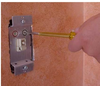
**Figura 5.7. Selección de la dirección en un Módulo X10**
