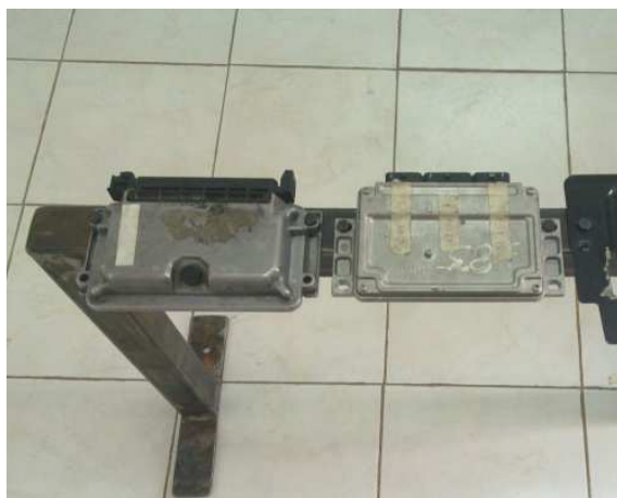
Gráfico No. 3.39: Módulos electrónicos a hermanar.
