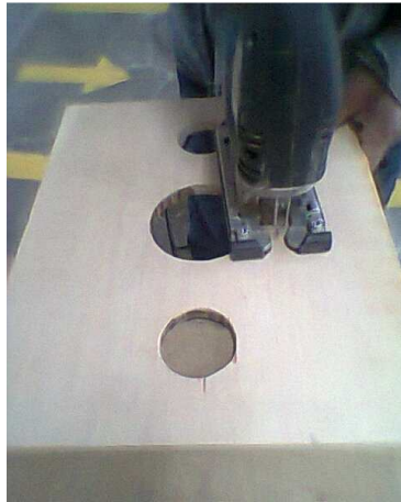
Gráfico No. 3.42: Construcción de la parte frontal del tablero de instrumentos.
