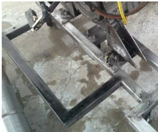
Gráfico No. 3.12: Base del tanque de combustible.
