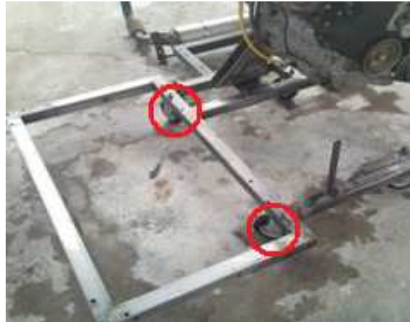
Gráfico No. 3.10: Colocación de las ruedas debajo de la estructura.
