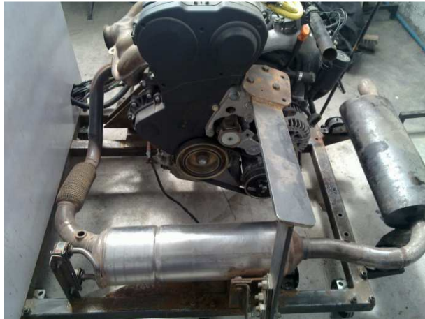
Gráfico No. 3.16: Montaje del sistema de escape.
