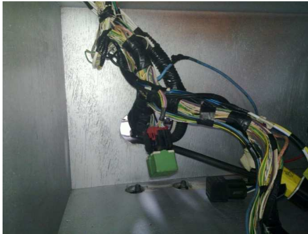
Gráfico No. 3.27: Cableado del habitáculo del vehículo.
