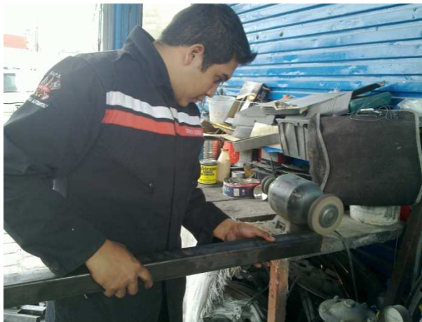
Gráfico No. 3.2: Corregido de superficies de corte.
