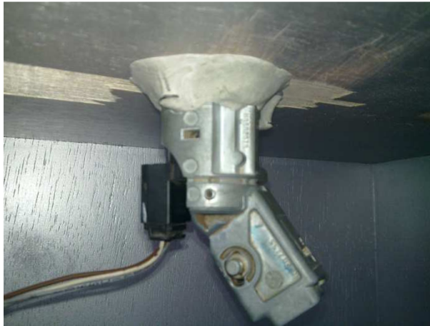
Gráfico No. 3.57: Sujeción del interruptor de encendido.
