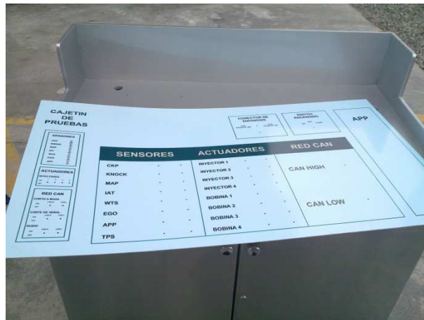
Gráfico No. 3.48: Sobre posición del plotter impreso sobre el banco de pruebas.
