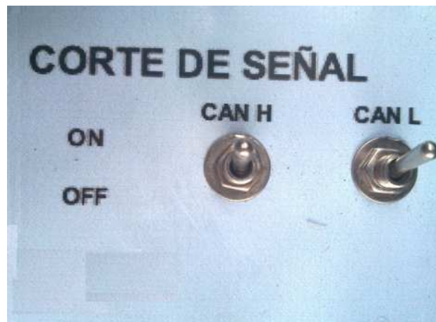
Gráfico No. 4.8: Interruptores de corte de señal.
