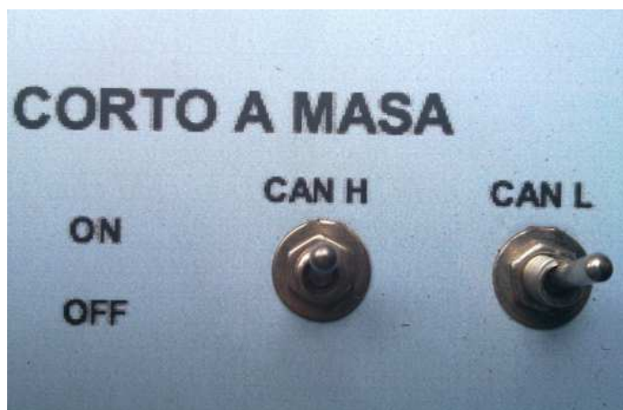
Gráfico No. 4.5: Interruptores de corte a masa.
