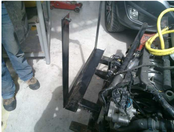
Gráfico No. 3.18: Montaje de la base del radiador.
