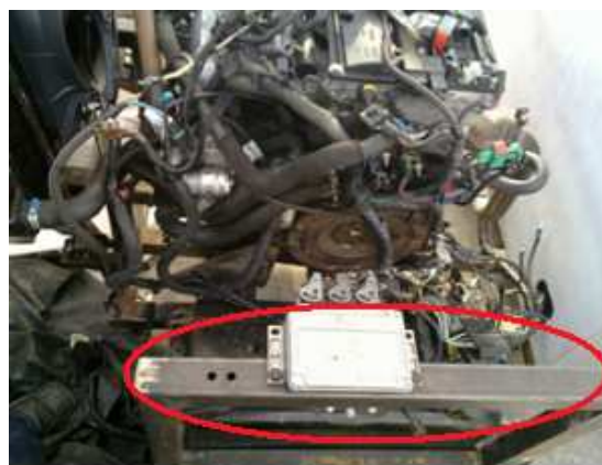
Gráfico No. 3.23: Lugar escogido para el montaje de módulos
