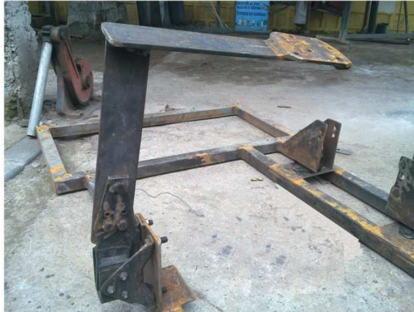
Gráfico No. 3.7: Base superior del motor.
