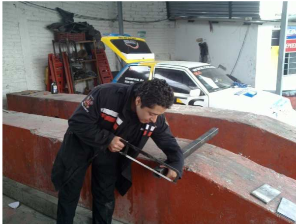
Gráfico No. 3.1: Corte de tubos de acero.
