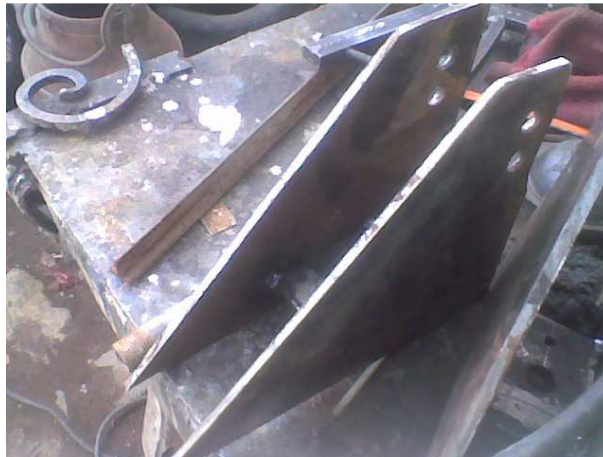
Gráfico No. 3.5: Fabricación de la base del motor.
