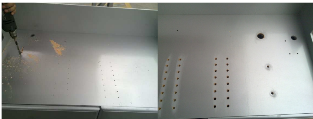
Gráfico No. 3.49: Perforación del banco de madera para ubicar elementos de control y medición.
