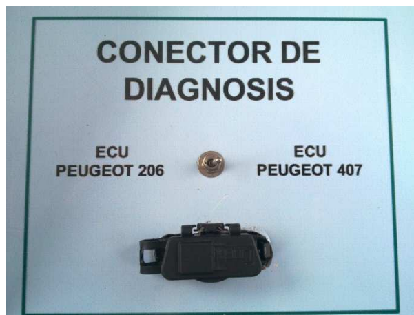
Gráfico No. 3.60: Montaje conector OBDII
