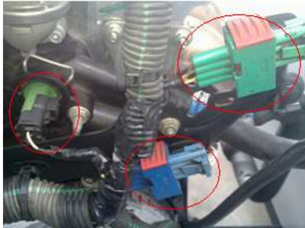
Gráfico No. 3.29: Conexión de sensores.
