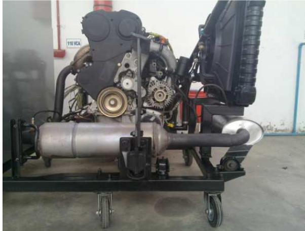
Gráfico No. 3.11: Colocación del motor en la estructura.
