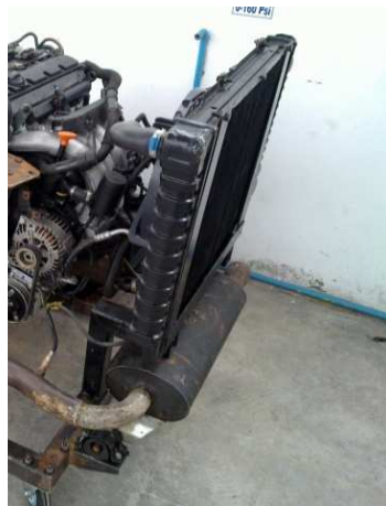
Gráfico No. 3.21: Montaje de radiador y ventilador.
