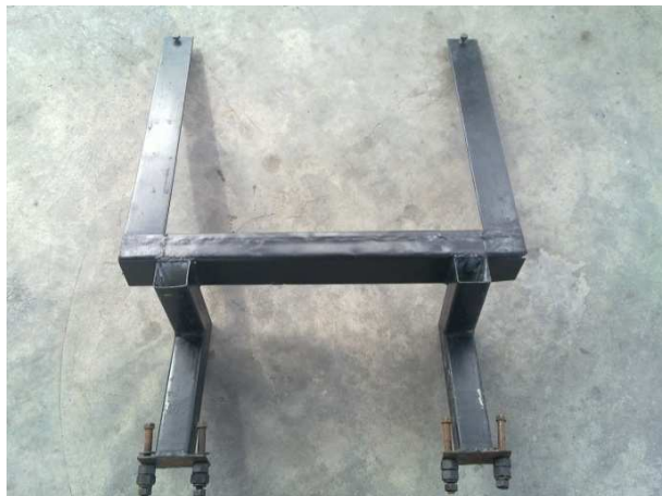
Gráfico No. 3.17: Base para el ventilador y el radiador.
