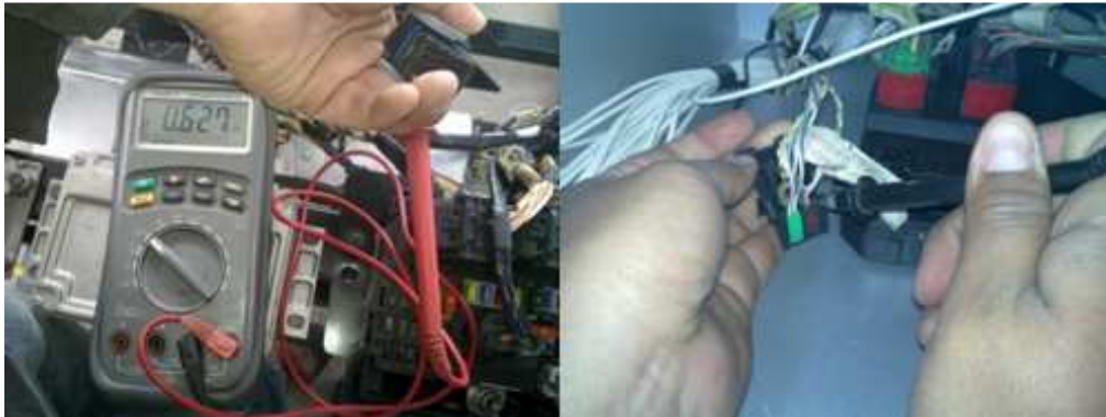
Gráfico No. 3.38: Continuidad entre módulos.
