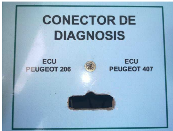
Gráfico No. 3.59: Colocación del interruptor en el conector OBD II.
