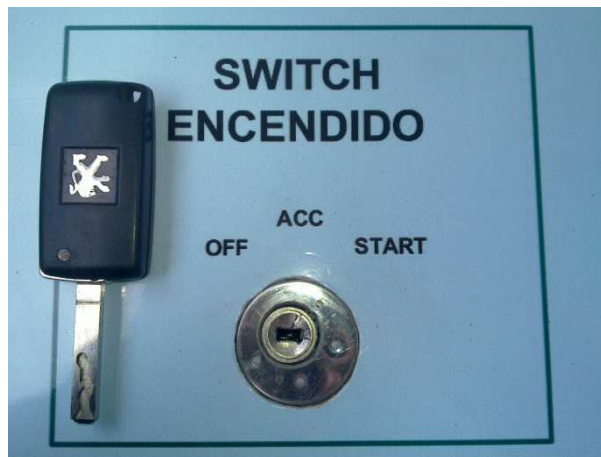
Gráfico No. 3.56: Montaje del interruptor de encendido.
