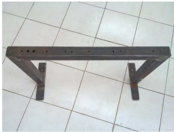
Gráfico No. 3.22: Base para módulos electrónicos.
