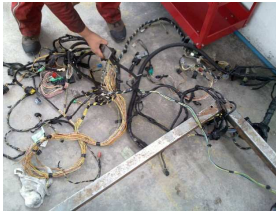
Gráfico No. 3.26: Cableado del motor.
