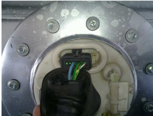
Gráfico No. 3.31: Conexión bomba de combustible.
