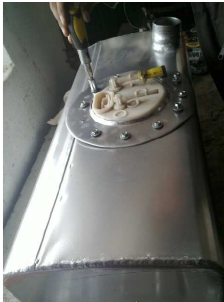
Gráfico No. 3.13: Tanque de combustible.
