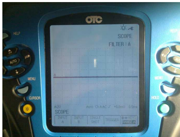
Gráfico No. 4.6: Corte de señal CAN HIGH.
