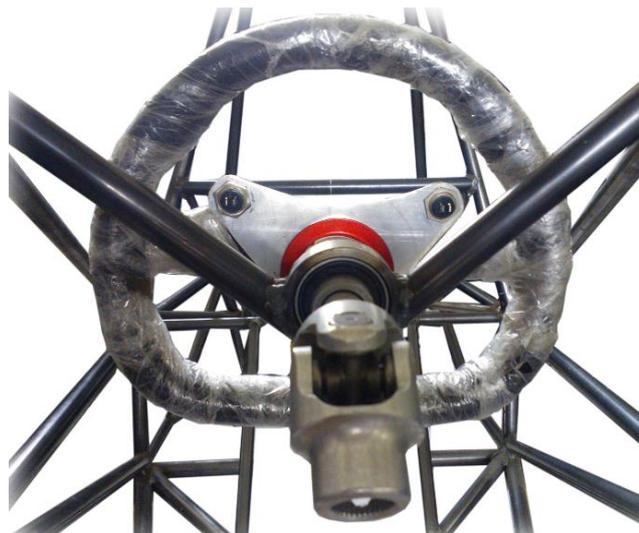
Figura 3.23. Soportes del volante
