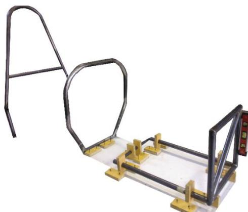
Figura 3.7. Construcción y ensamble del arco principal
