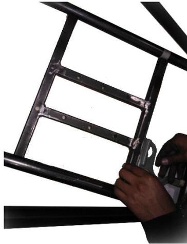
Figura 3.27. Base de la caja de pedales
