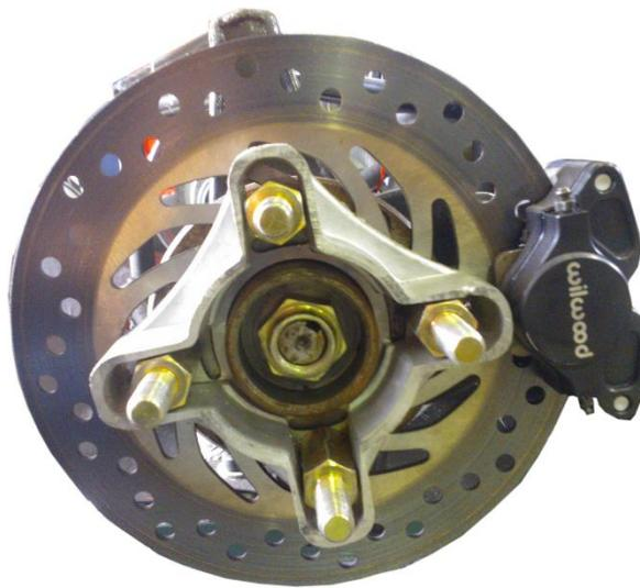
Figura 3.30. Conjunto disco-mordaza ensamblado
