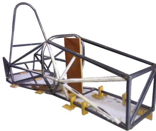
Figura 3.9. Triangulación frontal del bastidor
