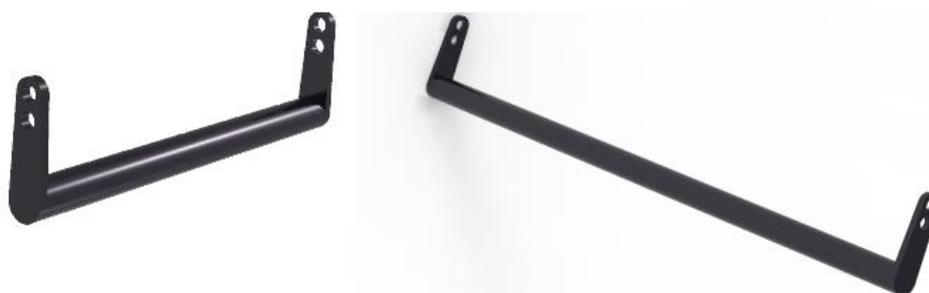
Figura 2.72. Barra estabilizadora frontal y posterior
