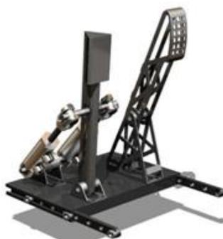
Figura 1.39. Configuraciones de cilindros maestros
