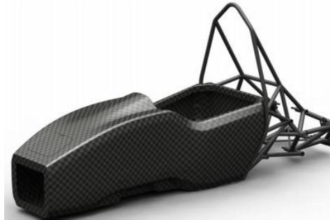
Figura 1.33. Configuración de un bastidor híbrido
