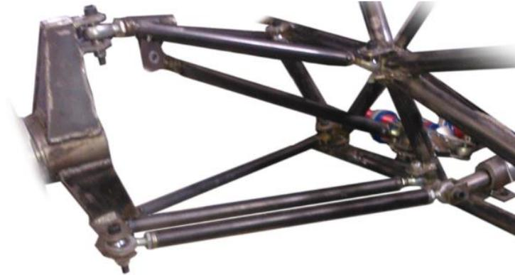
Figura 3.24. Brazos de dirección ensamblados
