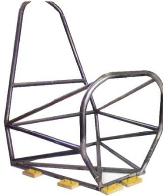
Figura 3.8. Construcción y ensamble de la protección lateral
