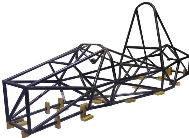
Figura 3.11. Bastidor ensamblado completamente
