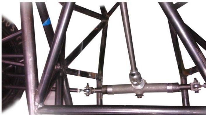
Figura 3.25. Brazos de dirección ensamblados
