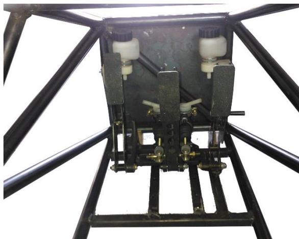
Figura 3.28. Ensamble de la caja de pedales y reservorios
