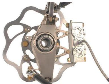
Figura 1.43. Conjunto de disco de freno utilizados en FSAE
