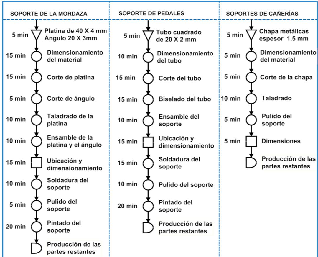
Figura 3.31. Proceso de construcción y ensamble para el sistema de frenos
