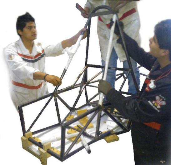
Figura 3.10. Triangulación posterior del bastidor
