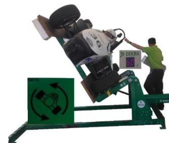
Figura 28: Prueba de inclinación del vehículo
