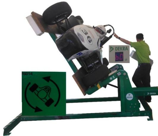
Figura 4.5. Prueba de inclinación del vehículo
