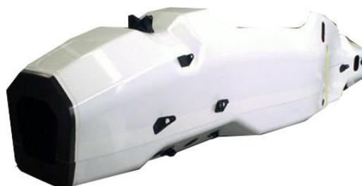
Figura 1.32. Ejemplo de bastidor monocasco
