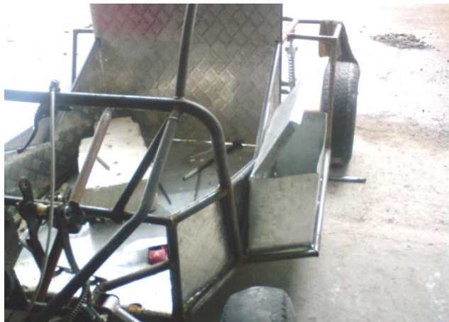
Fig. 4. 34 Instalación de los absorbedores de impacto.
