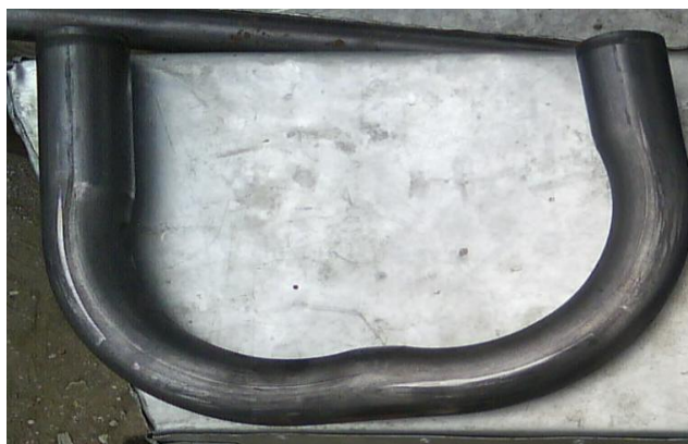
Fig. 4. 6 Doblado de tubos por presión.
