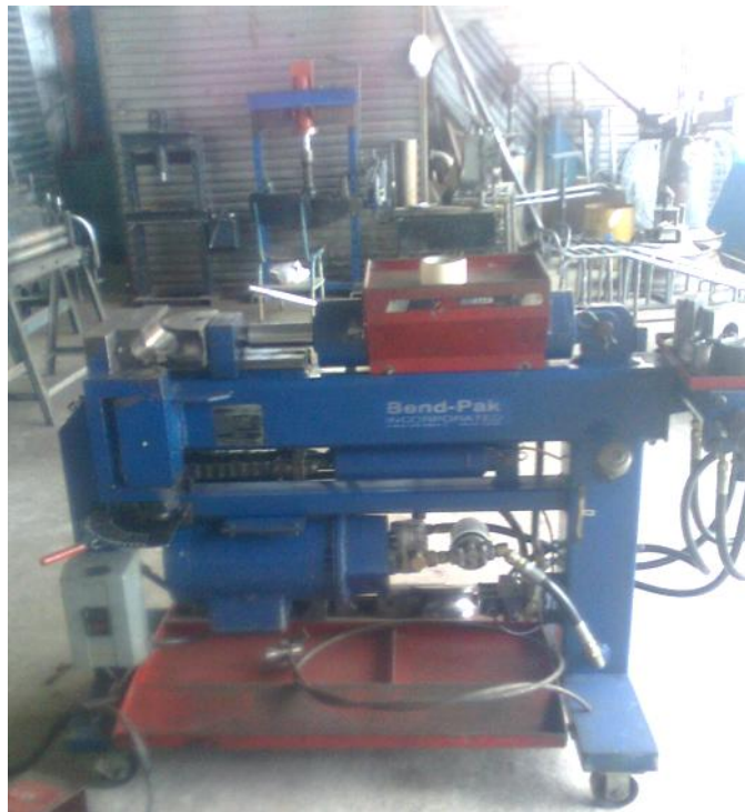
Fig. 4. 5 Maquina dobladora de tubos utilizada en el proyecto.
