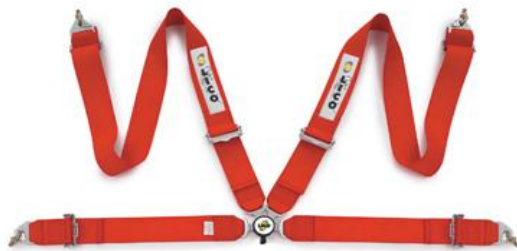
Fig. 2. 9 Cinturón de seguridad de cuatro arneses utilizados en los autos de competición.
