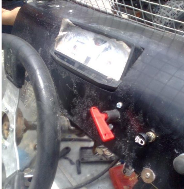
Fig. 4. 37 Tablero de Control del Buggy
