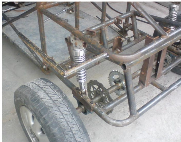
Fig. 4. 25 Instalación de Sistema de Suspensión Trasera.
