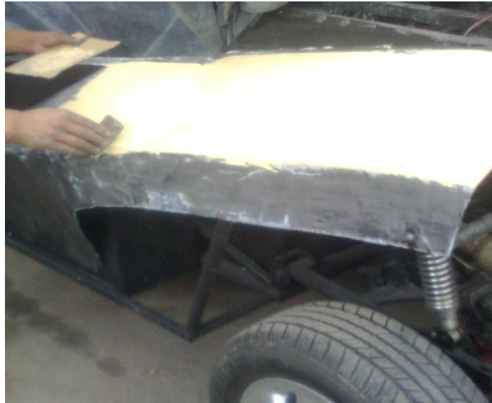
Fig. 4. 42 Proceso de masillado.
