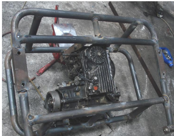
Fig. 4. 20 Construcción de bastidor para el tren de potencia.
