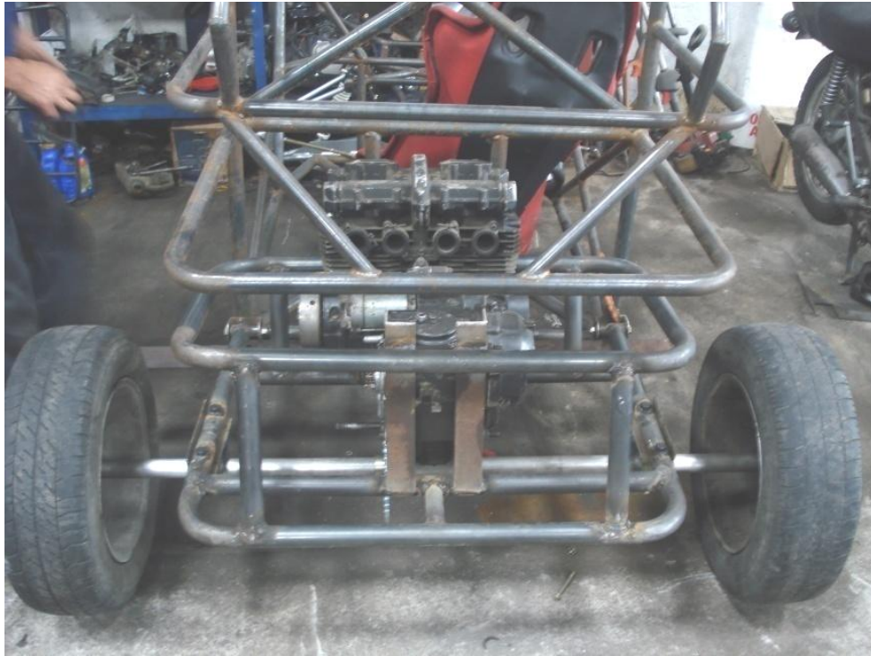
Fig. 4. 22 Ensamblaje total del Tren de Potencia
