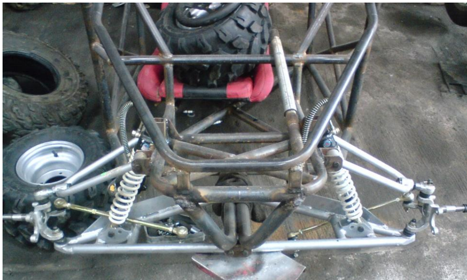
Fig. 4. 24 Sistema de Suspensión delantera del Buggy.
