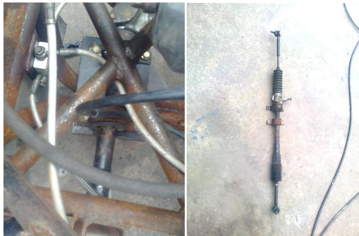
Fig. 4. 32 Fijación del Mecanismo de Cremallera.
