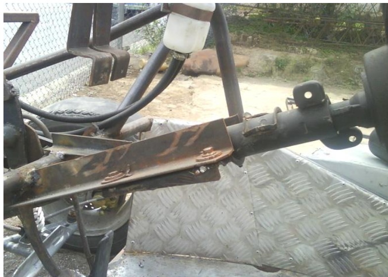
Fig. 4. 30 Fijación de la barra de dirección.
