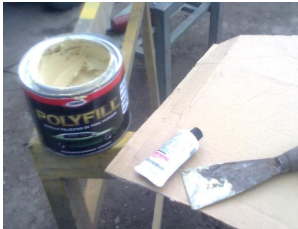
Fig. 4. 41 elementos para la preparación de la masilla
