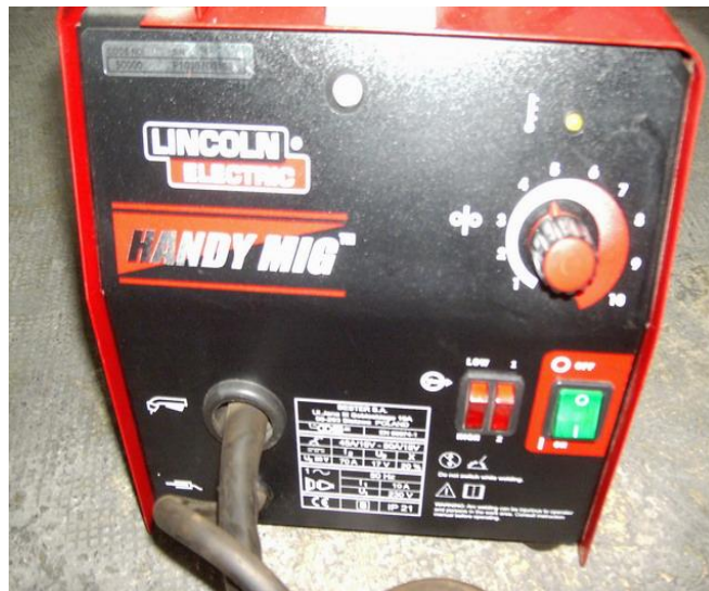
Fig. 4. 7Máquina de soldadura GMAW utilizada.
