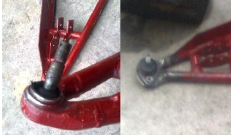
Fig. 4. 50 Sustitución de rotulas inferiores.
