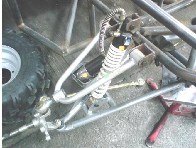
Fig. 4. 23 Sistema de Suspensión Delantera Independiente a ser instalada
