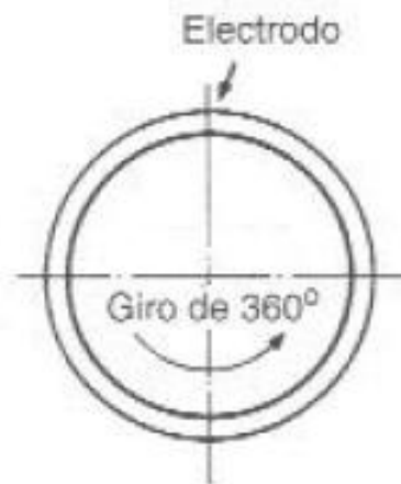
Fig. 4. 8 Soldadura circular a 360°
