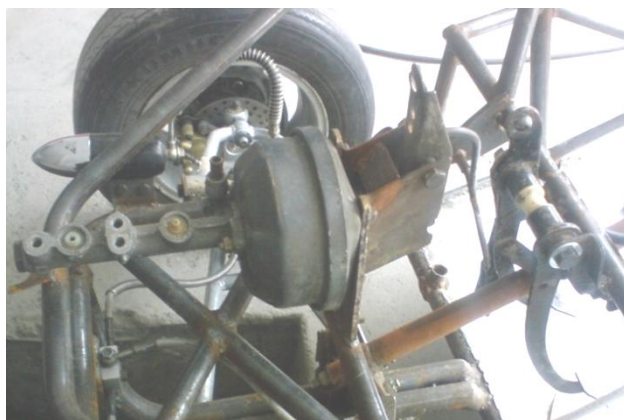
Fig. 4. 27 Montaje de la bomba y pedal de freno
