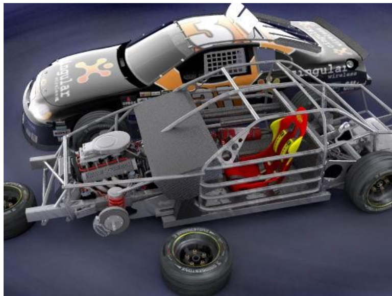
Fig. 1. 3 Ejemplo de un chasis tubular utilizado para competencia.
