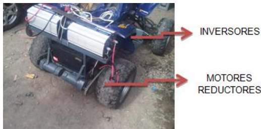
Figura 3.10 Inversores y Motores reductores
