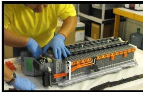
Figura 1.14 Batería de Alta tensión
