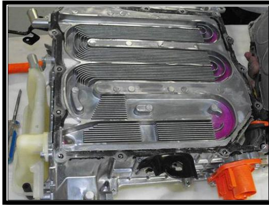
Figura 1.12 Conductos de refrigeración en el interior del Inversor
