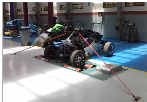
Figura 41 Vehículo prototipo en el dinamómetro para la prueba de potencia
