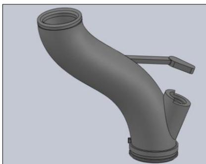
Figura 11 Diseño de los conductos de admisión
