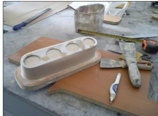
Figura 27 Molde negativo del pleno inferior
