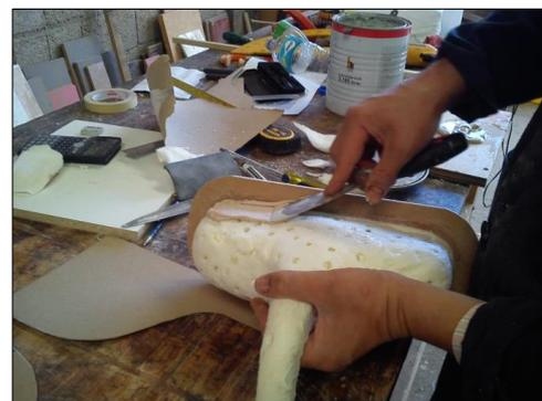
Figura 24 Aplicación de masilla mustang en el molde de espuma de poliuretano
