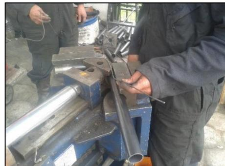
Figura 32 Doblado de los tubos primarios
