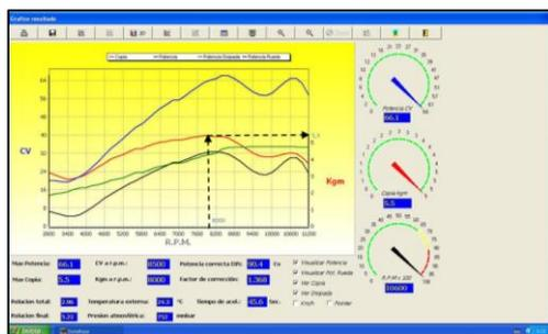
Figura 44 Curva de torque obtenida en el dinamómetro.
