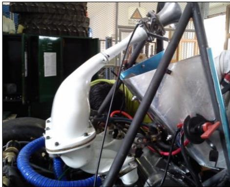
Figura 30 Cierre hermético del sistema mediante empaques
