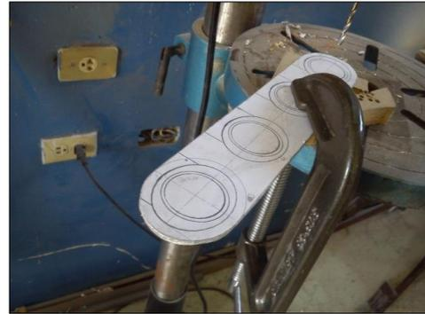
Figura 26 Placa de aluminio con los agujeros para los conductos de admisión
