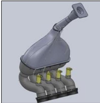
Figura 10 Diseño del colector de admisión
