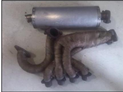
Figura 38 Sistema de salida de gases.
