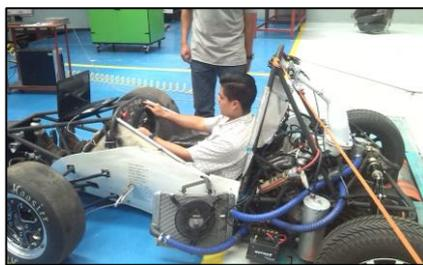
Figura 43 Vehículo prototipo en el dinamómetro durante la prueba torque
