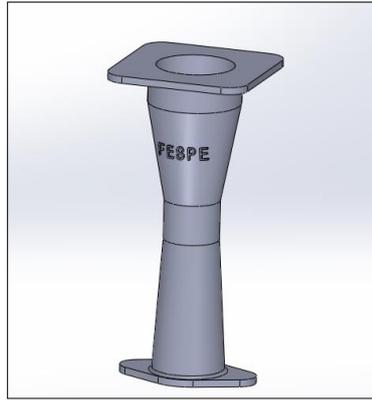
Figura 9 Diseño del difusor tipo venturi con un ángulo de salida de 7 grados
