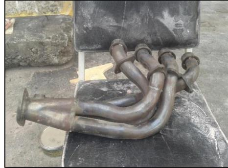
Figura 36 Tubos primarios con el colector
