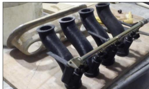
Figura 28 Pleno inferior con los agujeros para los conductos de admisión
