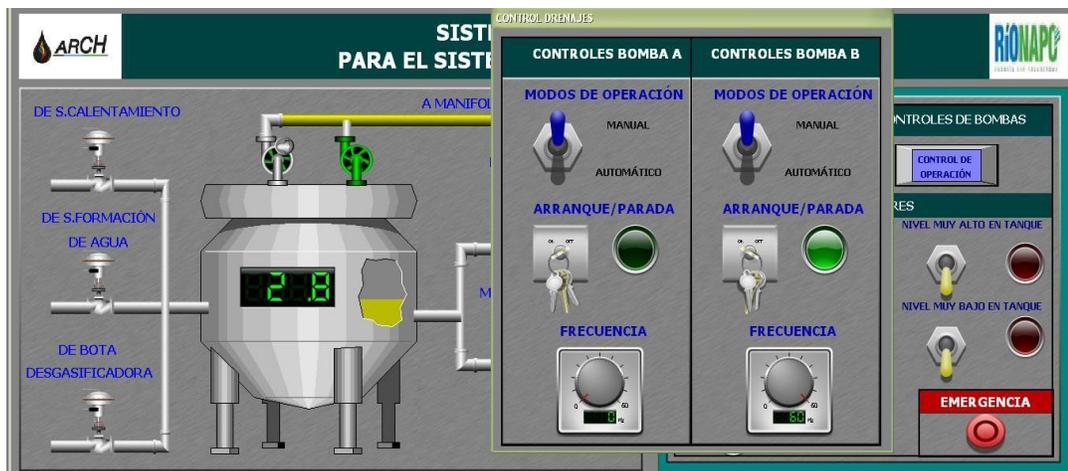
Figura 157. Operación manual del sistema de drenaje
