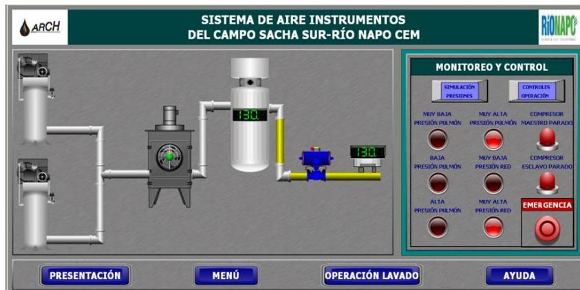
Figura 132. Pantalla del sistema de aire instrumentos
