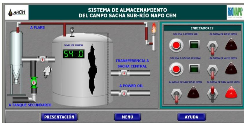
Figura 133. Pantalla del sistema de Almacenamiento
