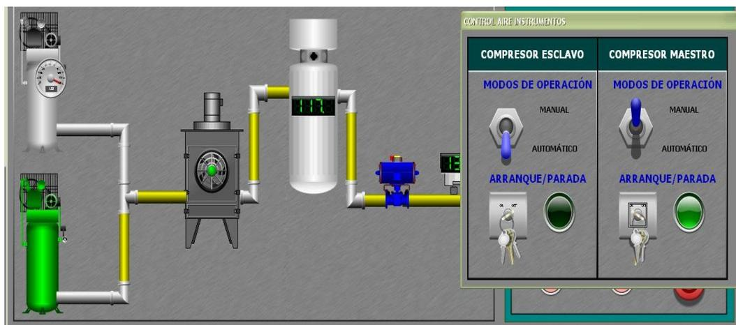
Figura 159. Operación manual del sistema de aire de instrumentos
