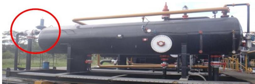
Figura 30. Válvula de ingreso a separadores de producción.
