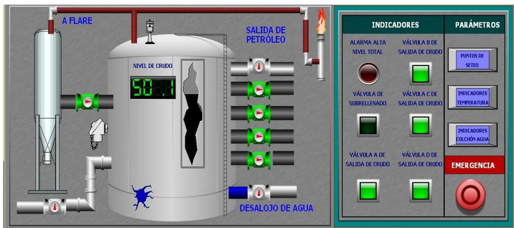
Figura 153. Tanque Multipropósito en la deshidratación del crudo
