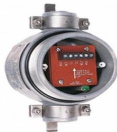
Figura 80. Interruptor de nivel magnético.
