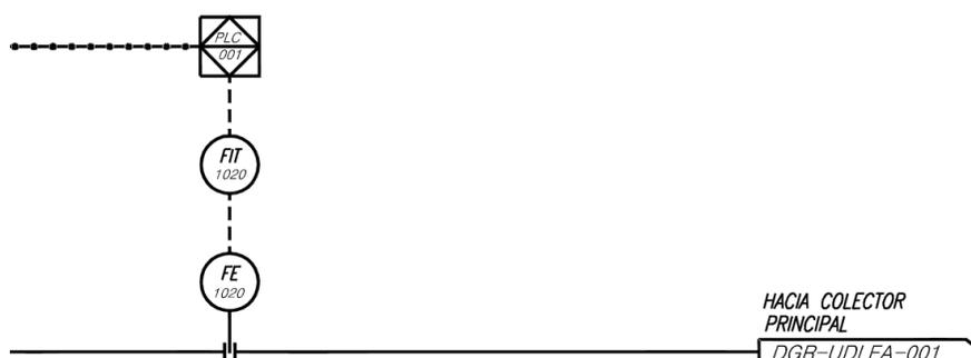
Figura 65. Esquema de salida de bombeo de fluido
