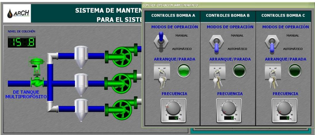
Figura 152. Controles manuales de las bombas de desalajo
