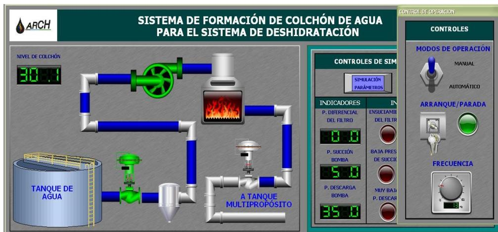
Figura 148. Control manual de la bomba de formación
